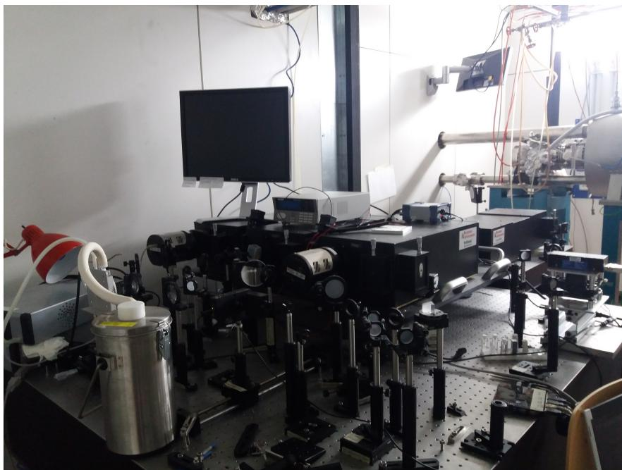
Σχήμα 4.32: Το τριπλό φασματόμετρο και τα οπτικά της πειραματικής διάταξης στη δέσμη IUVS
