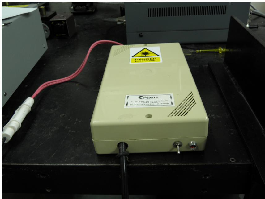
Σχήμα 4.14: Τροφοδοτικό υψηλής τάσης.
