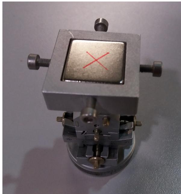
Σχήμα 4.29: Η διάταξη εφαρμογής μαγνητικού πεδίου κάθετα στην επιφάνεια του δείγματος
