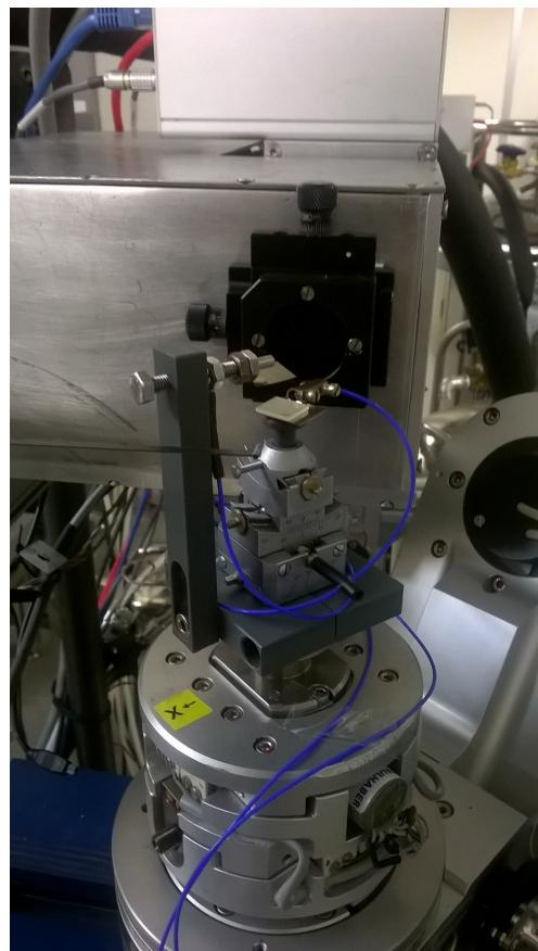
Σχήμα 4.28: Διάταξη εφαρμογής ηλεκτρικού πεδίου σε επιταξιακό υμένιο
