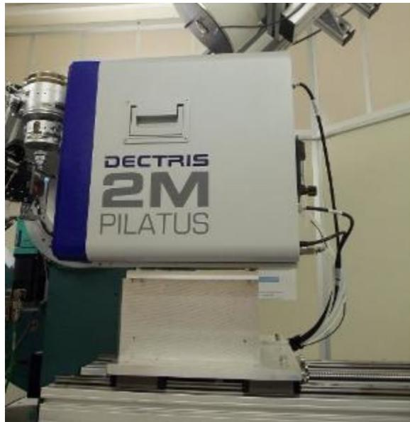
Σχήμα 4.26: Δισδιάστατος ανιχνευτής 2M Pilatus
