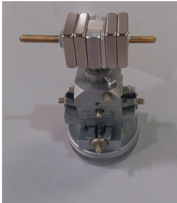
Σχήμα 4.30: Η διάταξη εφαρμογής μαγνητικού πεδίου παράλληλα στην επιφάνεια του δείγματος
