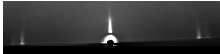
Σχήμα 9.82: Τα diffraction rods όπως φαίνονται στο περιυλασίγραμμα
