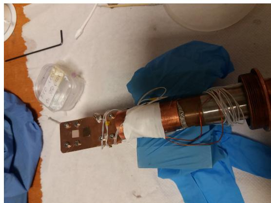
Σχήμα 4.35: Ο δειγματοφορέας του χρυσοστάτη με τοποθετημένο ένα από τα επιταξιακά υμένια και ένα κομμάτι επιχρυσωμένου καθρέφτη.
