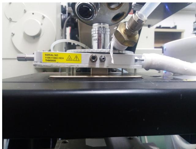
Σχήμα 4.18: Παραλληλεπίπεδος μαγνήτης νεοδυμίου τοποθετημένος εκτός του κρυοστάτη Linkham ακριβώς πίσω από το δείγμα
