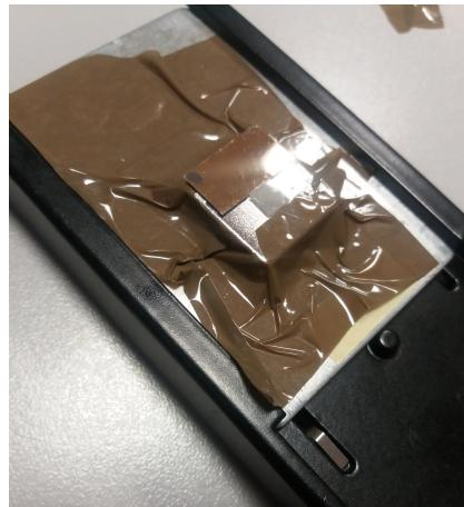
Σχήμα 4.37: Ο μαγνήτης των 0.4 T με ένα από τα επιταξιακά υμένια τοποθετημένος στον δειγματοφορέα για τις μετρήσεις σε θερμοκρασία περιβάλλοντος
