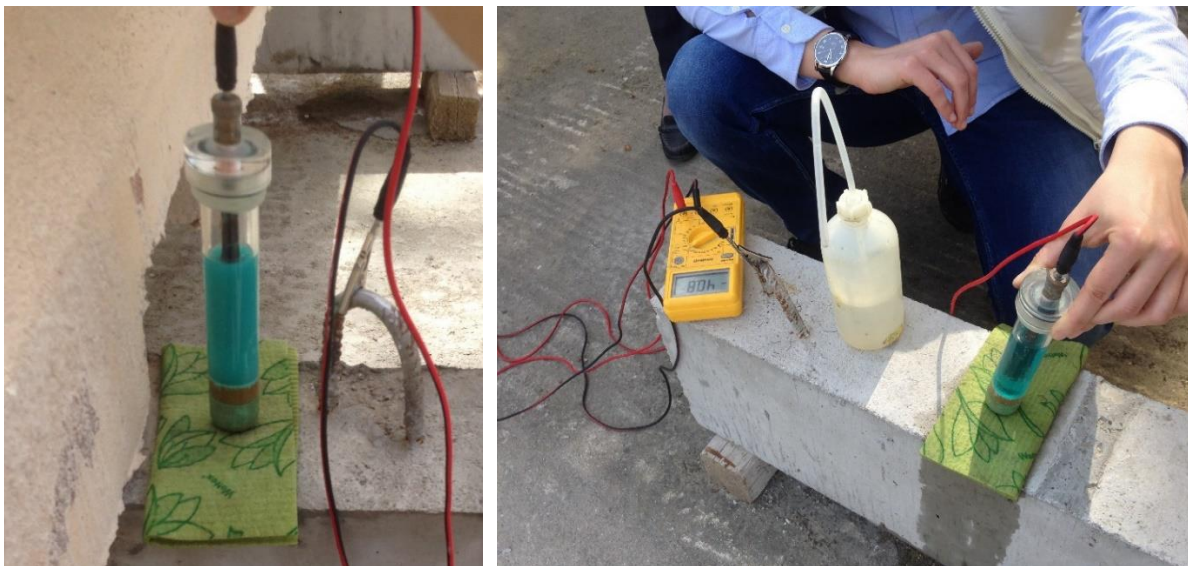
Εικόνα 6. 5 Ηλεκτρόδιο αναφοράς χαλκού σε κορεσμένο χαλκό (αριστερά), δοκιμή στο πεδίο (δεξιά)
