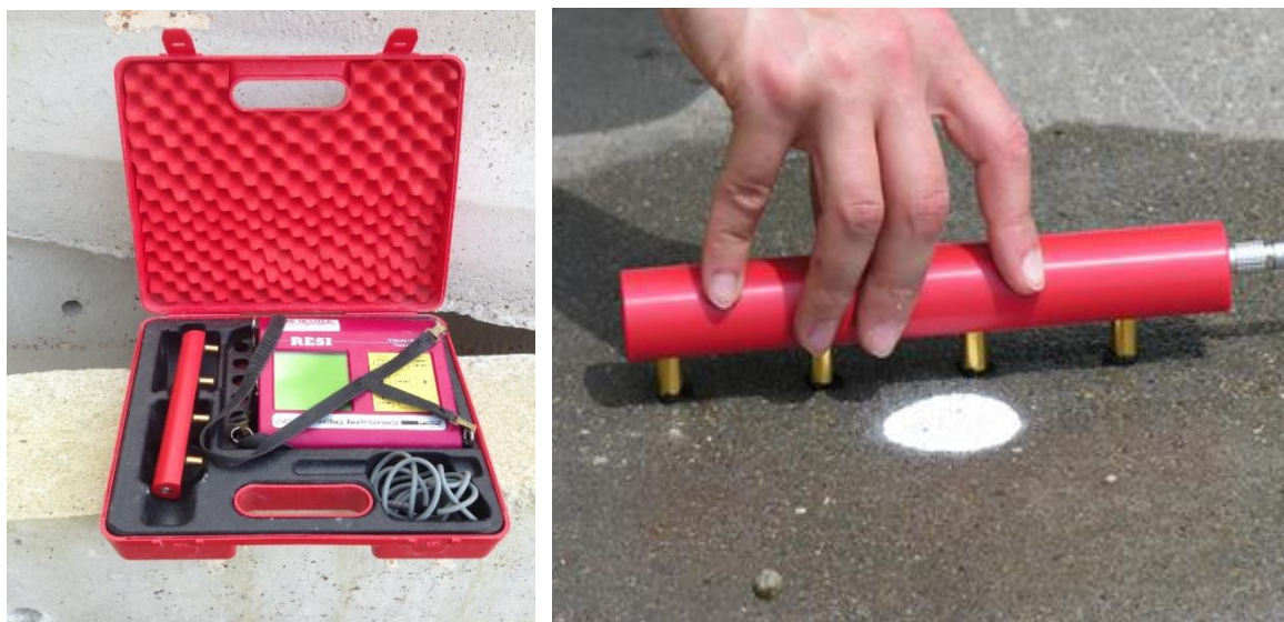
Εικόνα 6. 6 Μετρητής αντίστασης τεσσάρων ηλεκτροδίων (Wenner probe) – δοκιμή πεδίου
