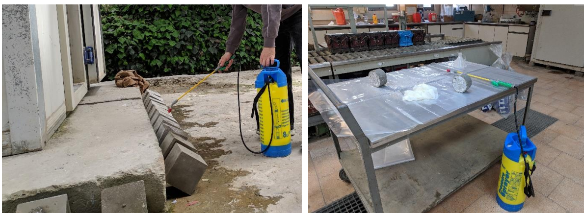
Εικόνα 5. 2 Εφαρμογή χειροκίνητου ψεκασμού σε δύο στρώσεις σε κυβικά (αριστερά) και κυλινδρικά (δεξιά) δοκίμια
