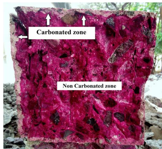
Σχήμα 6. 5 Σκαρίφημα του θαλάμου ενανθράκωσης (αριστερά), μέτρηση βάθους ενανθράκωσης μετά από εμποτισμό με διάλυμα φαινολοφθαλεΐνης (δεξιά)
