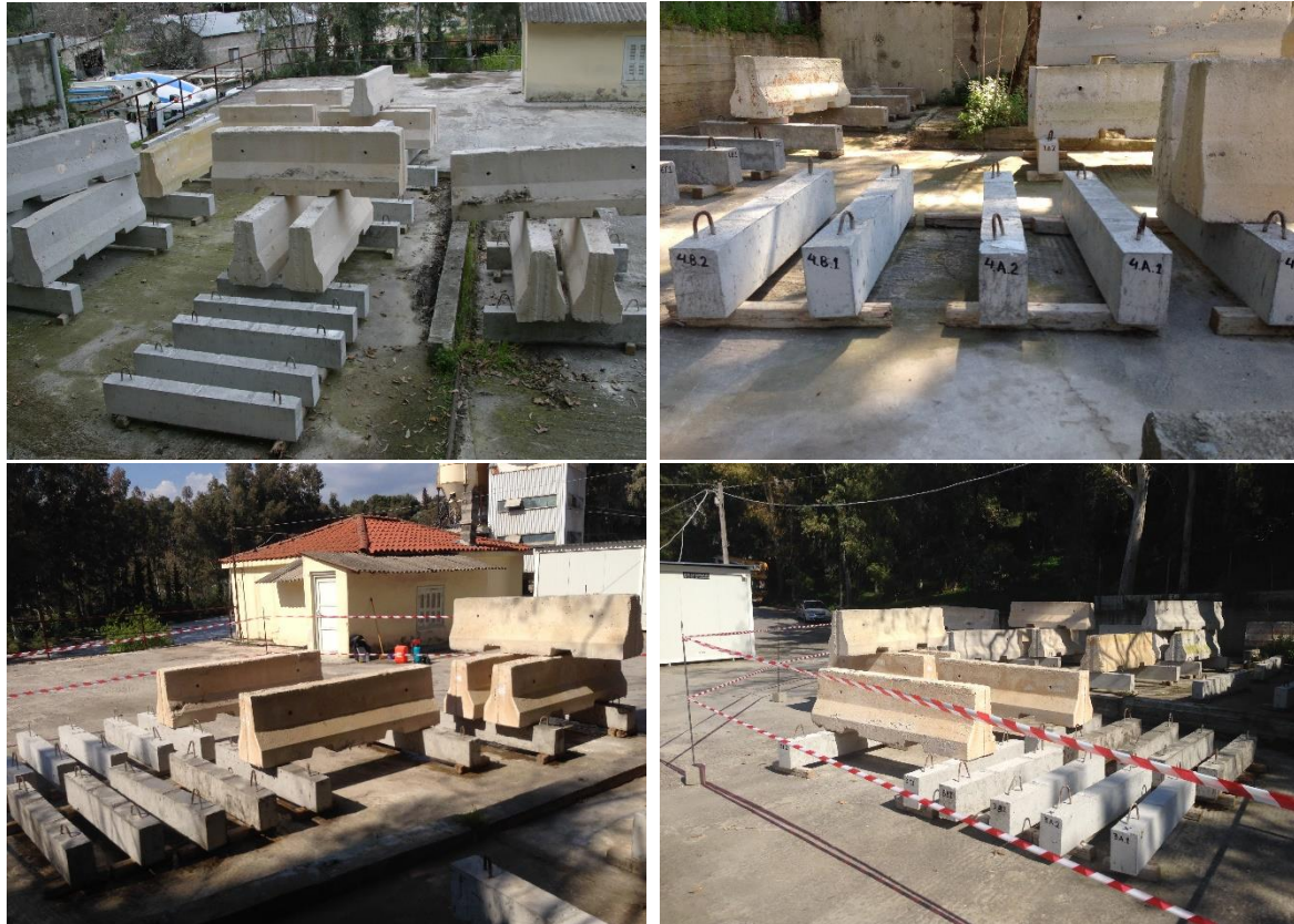
Εικόνα 5. 5 Διάταξη δοκών οπλισμένου σκυροδέματος στο πεδίο
