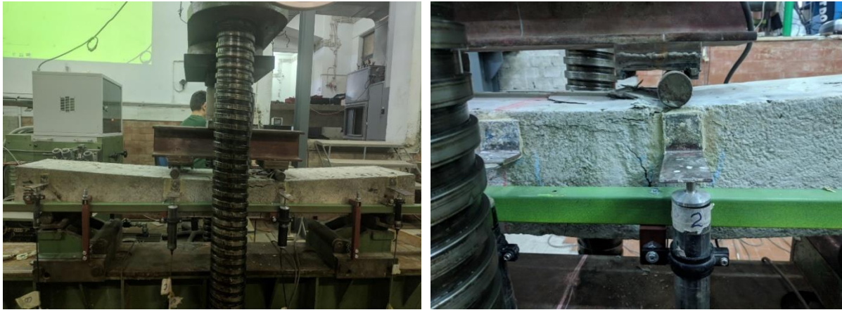
Εικόνα 6. 15 Θραύση δοκίμιου (αριστερά) και λεπτομέρεια δοκού μετά την αστοχία (δεξιά)
