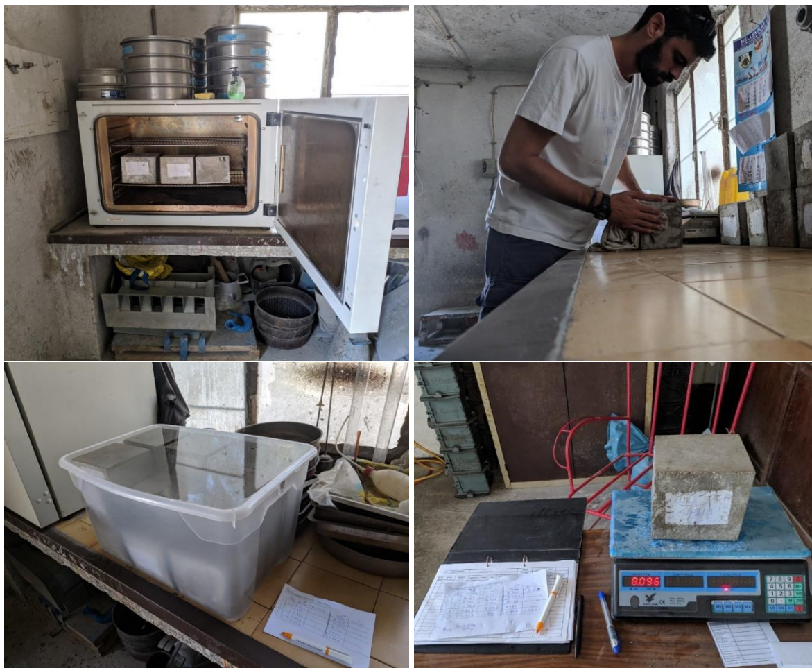
Εικόνα 6. 9 Στάδια διαδικασίας προσδιορισμού της υδατοαπορροφητικότητας κυβικών δοκιμίων κατά BS1881
