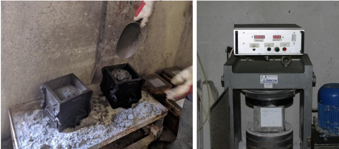
Εικόνα 6. 1 Πλήρωση και δόνηση μεταλλικών μητρών (αριστερά), δοκιμή θλίψης κυβικού δοκιμίου (δεξιά)
