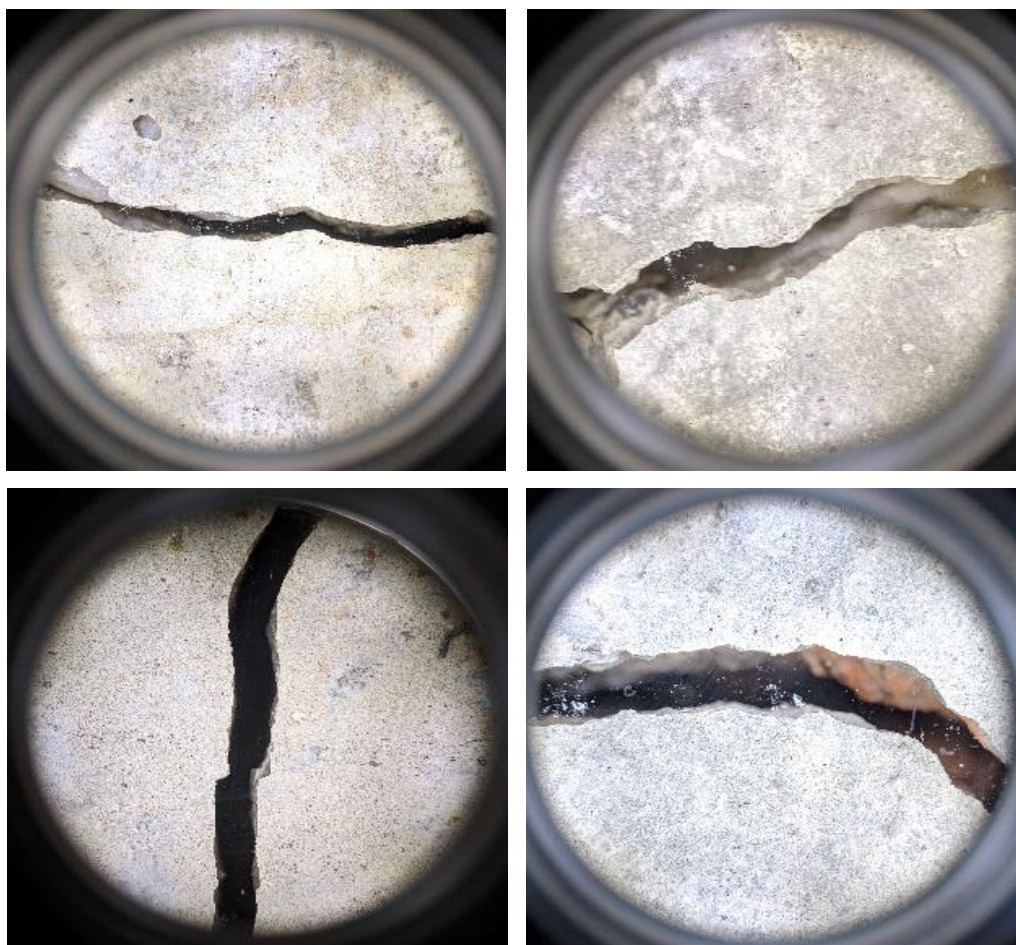
Σχήμα 7. 68 Παρακολούθηση και καταγραφή πλάτους ρωγμών με ειδικό μικροσκόπιο
