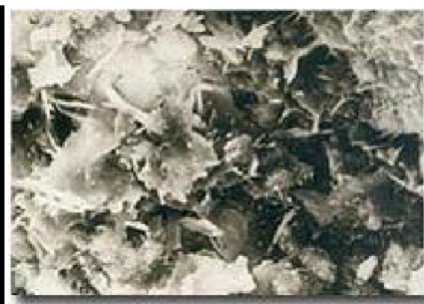
Εικόνα 1.2.β Προϊόν Ενυδάτωσης Πυριτικού διασβεστίου (C 2 S)
