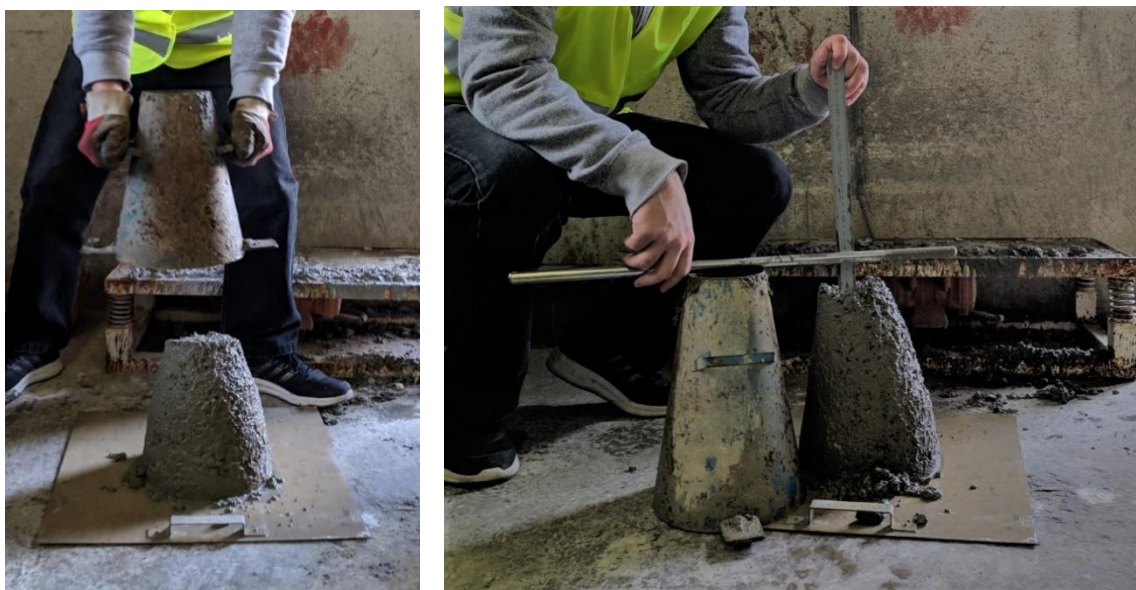
Εικόνα 6. 3 Έλεγχος εργασιμότητας - Δοκιμή κάθισης νωπού σκυροδέματος
