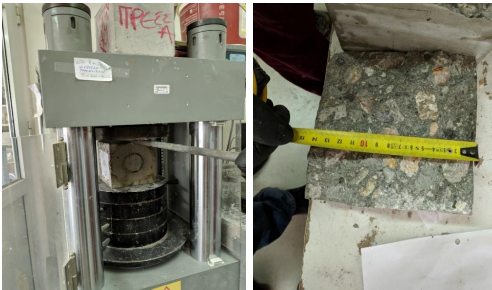
Εικόνα 6. 11 Θραύση στο μέσο του δοκιμίου (αριστερά) και μέτρηση βάθους διείσδυσης νερού (δεξιά)
