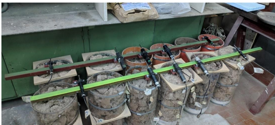
Εικόνα 6. 16 Διάταξη μηχανισιόμετρων DCDT στη δοκιμή κάμψης 4 σημείων
