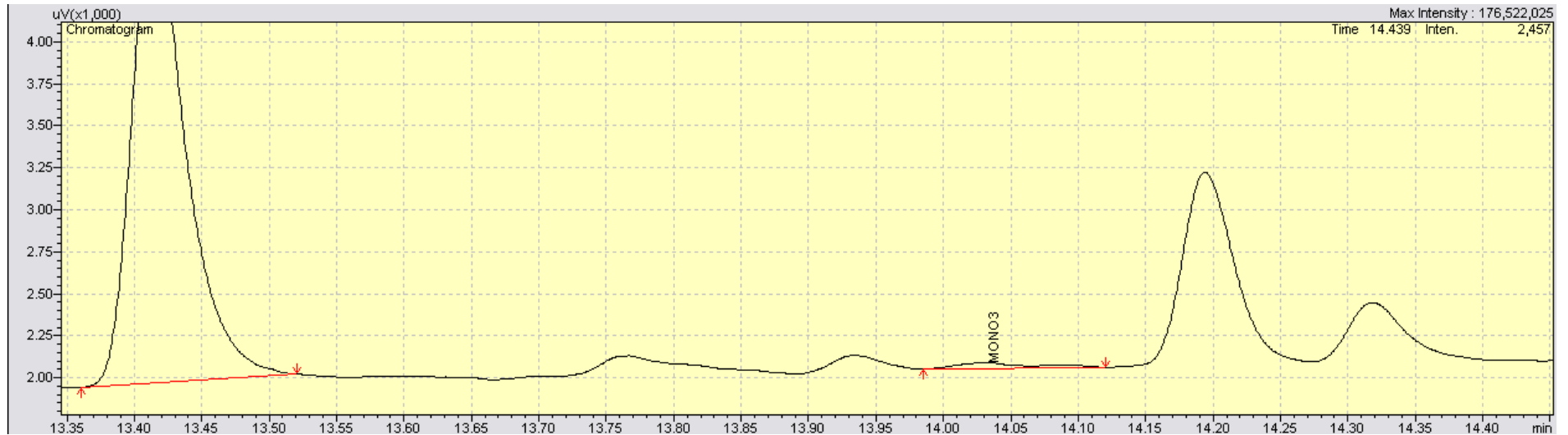
Γράφημα 35: Μεγέθυνση χρωματογραφήματος (MONO3) του δείγματος βιοντήζελ σισαμελαίου 7 (πάνω η κορυφή της πρώτης μεθόδου κάτω η δεύτερη).
