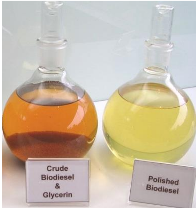
Εικόνα 14: Μίγμα ακατέργαστου βιοντήζελ και γλυκερίνης (αριστερά) και εξευγενισμένο ("καθαρό") βιοντήζελ (δεξιά). [εικόνα βιβλιογραφίας]
