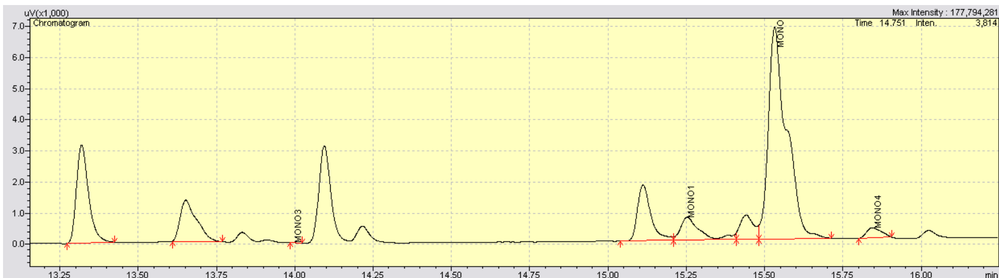
Γράφημα 54: Μεγέθυνση χρωματογραφήματος (μονογλυκερίδια) του δείγματος βιοντήζελ βαμβακελαίου 12 (πάνω η κορυφή της πρότυπης μεθόδου κάτω η δεύτερη)
