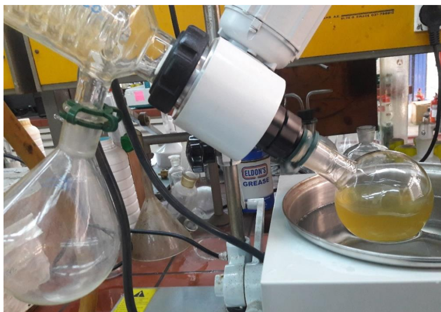
Εικόνα 6: Διάταξη περιστρεφόμενου εξατμιστήρα υπό κενό.
