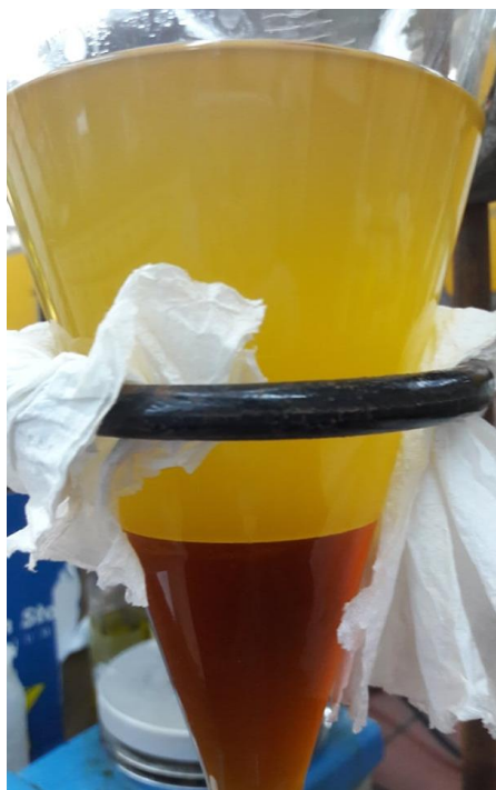
Εικόνα 3: Διεπιφάνεια γλυκερίνης-βιοντήζελ στην διαχωριστική χοάνη.
