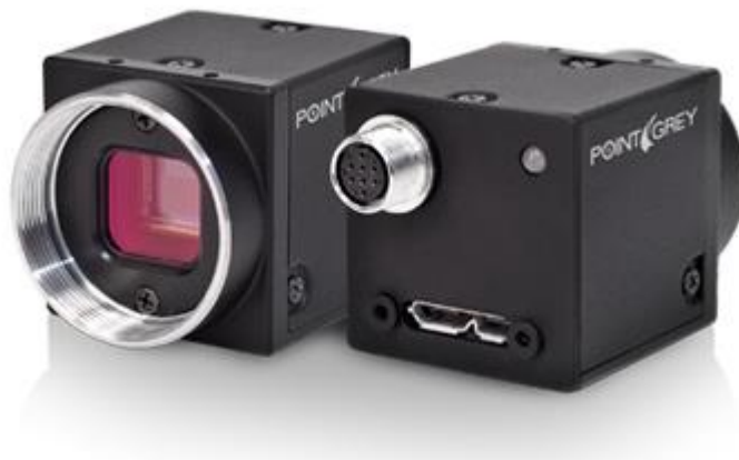
Εικόνα 12.2: Η κάμερα Flea3 USB 3.0 της διάταξης οπτικής καταγραφής.
