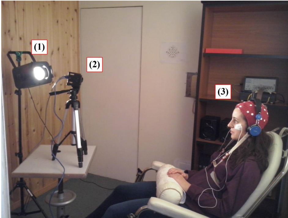
Εικόνα 12.1: Σύστημα οπτικής καταγραφής αντανακλαστικών. (1): Φωτισμός. (2): Κάμερα καταγραφής. (3): Σύστημα ηλεκτροεγκεφαλογράφου – ηλεκτρομυογράφου που χρησιμοποιείται για στάθμιση της μεθόδου.
