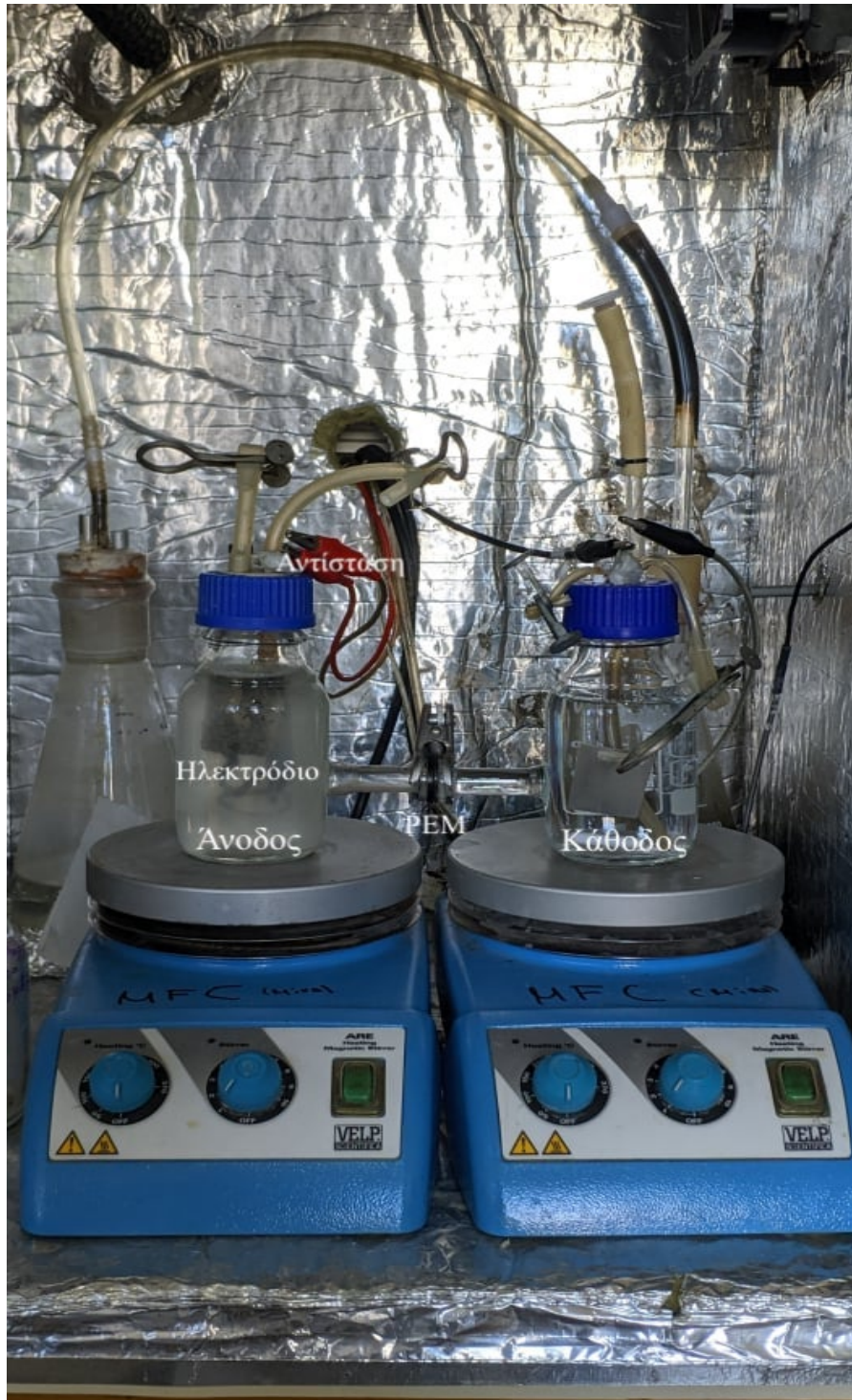
(Εικόνα 1. MKK δύο θαλάμων)
