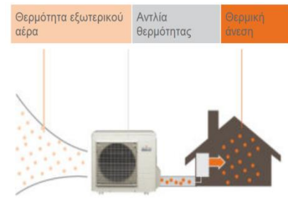
Εικόνα 2.5: Λειτουργία Αντλίας Θερμότητας με ατμοσφαιρικό αέρα (32)
