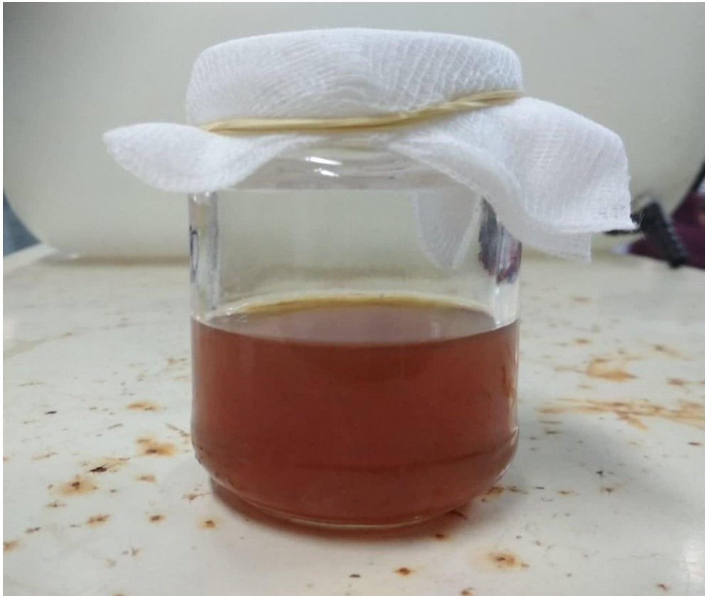
Εικόνα 7: Δοχείο ζύμωσης με εμβολιασμένο διάλυμα και καλυμμένο με αποστειρωμένη γάζα.
