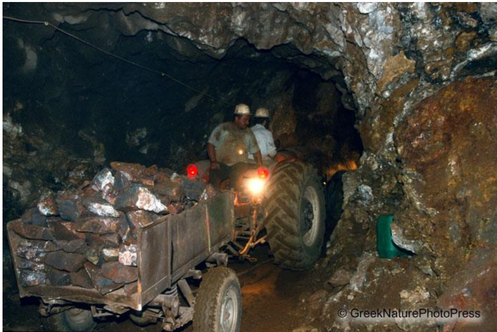
Εικόνα 3.6 Μεταφορά εξορυγμένης σμύριδας, όπου διακρίνεται επίσης και το πλάτος της στοάς (greekNatureFotoPress).
