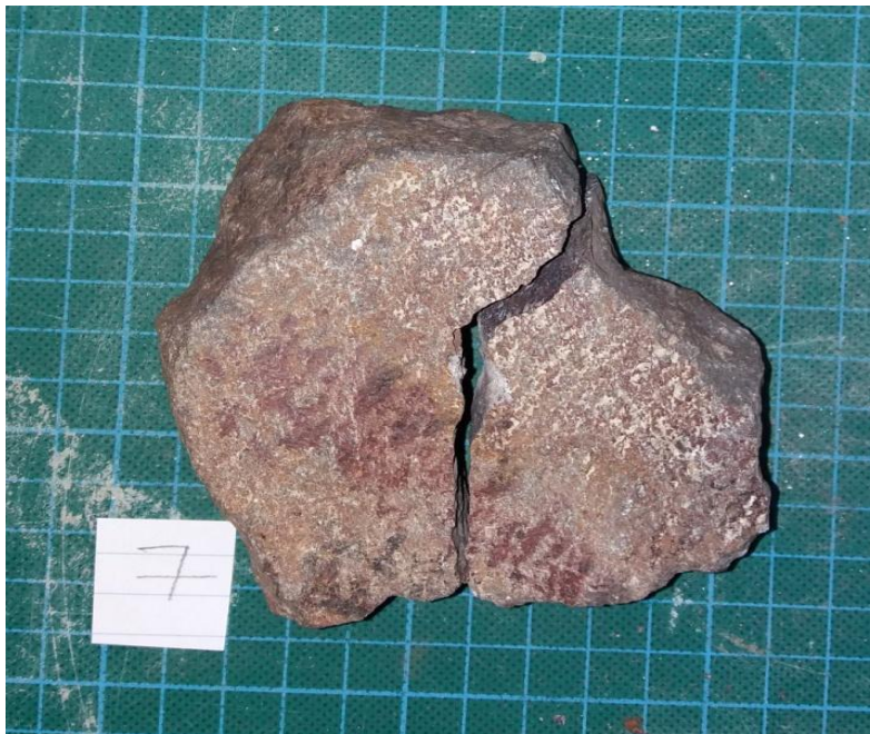
Εικόνα 4.8 Φωτογραφία σε κάτοψη αποδεκτής δοκιμής σημειακής φόρτισης.
