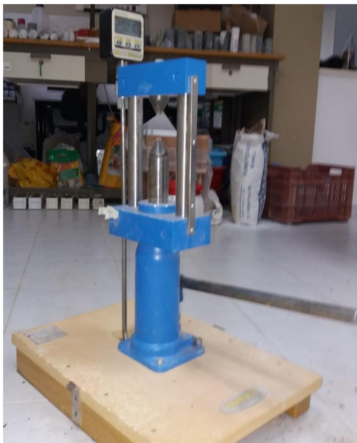
Εικόνα 4.2 Συσκευή σημειακής φόρτισης του Εργαστηρίου Τεχνολογίας Διάνοιξης Σηράγγων ΕΜΠ.
