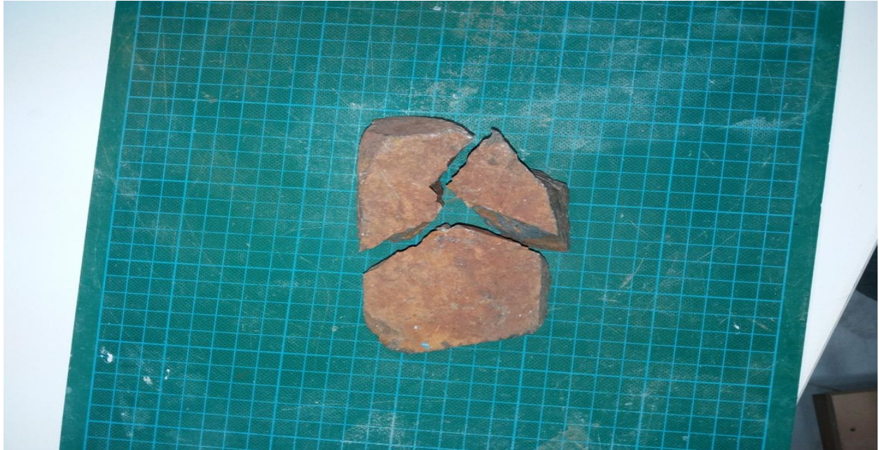
Δοκίμιο υπ' αριθμόν 1. Φωτογραφία μετά την θραύση του.
