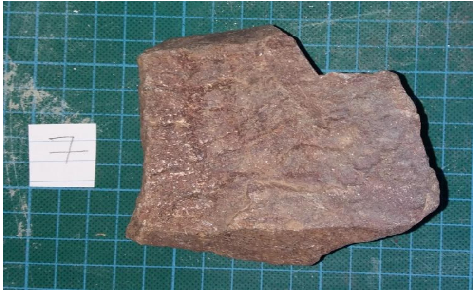
Εικόνα 4.4 Ενδεικτική φωτογραφία κάτωψης δοκιμίου που τηρεί τις παραμέτρους για να πραγματοποιηθεί σε αυτό δοκιμή σημειακής φόρτισης.
