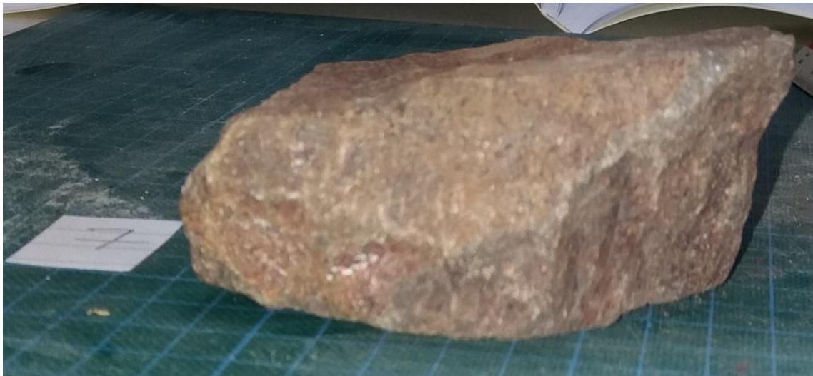
Εικόνα 4.5 Ενδεικτική φωτογραφία πλάγιας όψης δοκιμίου που τηρεί τις παραμέτρους για να πραγματοποιηθεί σε αυτό δοκιμή σημειακής φόρτισης.
