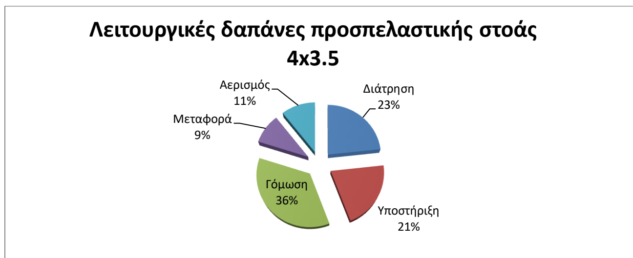
Σχήμα 7.3 Ποσοστιαία κατανομή λειτουργικών δαπανών προσπελαστικής στοάς 3.5x4.
