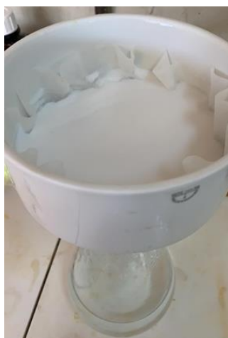
Εικόνα 12: Διήθηση για διαχωρισμό υγρού-στερεού
