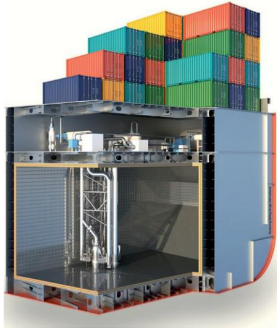
Σχήμα 28. Δεξαμενή τύπου μεμβράνης. [46]
