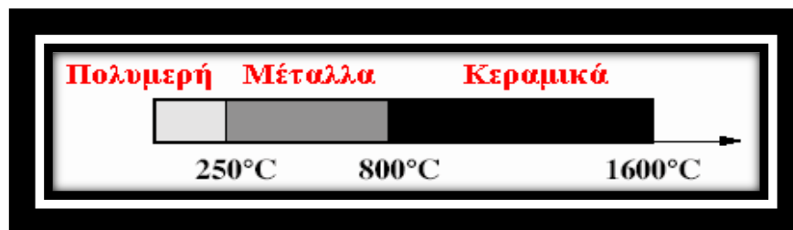
Σχήμα 1.2: Θερμοκρασιακά όρια χρήσης των υλικών.
