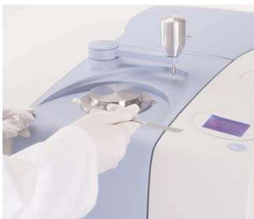
Εικόνα 32. Τοποθετώντας το δείγμα σε μορφή σκόνης στο όργανο ATR.
