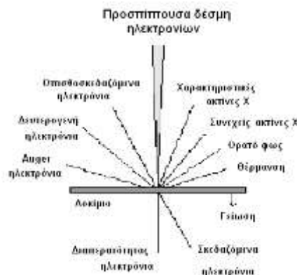
Εικόνα 29. Σχηματική αναπαράσταση της αλληλεπίδρασης δείγματος-δέσμης ηλεκτρονίων.
