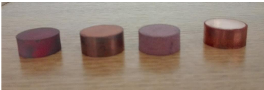
Εικόνα 4.2. (α) Πυροσυσσωματωμένο ηλεκτρόδιο Cu, (β) green compact ηλεκτρόδιο Cu-30 wt. % ZrO 2 , (γ) πυροσυσσωματωμένα ηλεκτρόδιο Cu-30 wt. % ZrO 2 και (δ) green compact ηλεκτρόδιο Cu.
