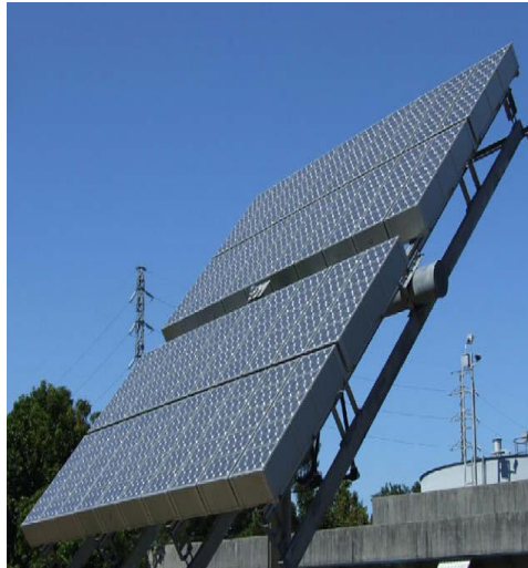
Εικόνα 5.1.2: 5 kW HCPV system (2nd generation) at INER. Διάγραμμα 5.1.6: I-V & P-V curves of a single module
