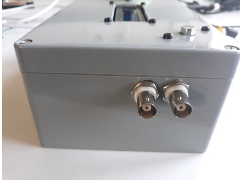
Σχήμα 58: Κουτί κατασκευής – οι BNC υποδοχές
