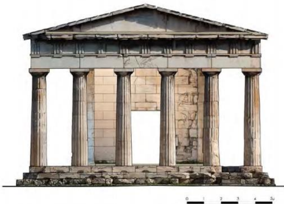
Εικόνα 15 : Δυτική όψη του ναού του Ηφαίστου, γραμμικό σχέδιο επάνω σε ορθοφωτογραφία
