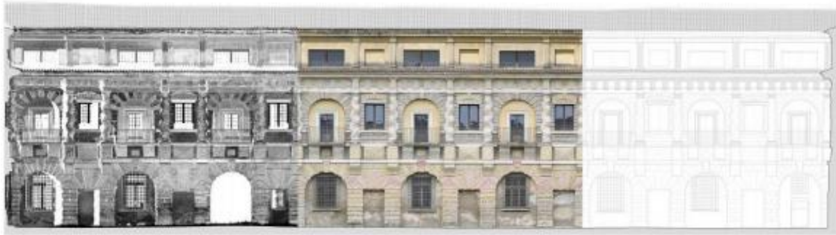
Εικόνα 20 : Ψηφιακή φωτοσύνθεση για την περιγραφή των διαφορετικών σταδίων της γεωμετρικής αποτύπωσης, από το νέφος σημείων (αριστερά), στην ορθοφωτογραφία (κέντρο) και στο διανυσματικό σχέδιο (δεξιά)
