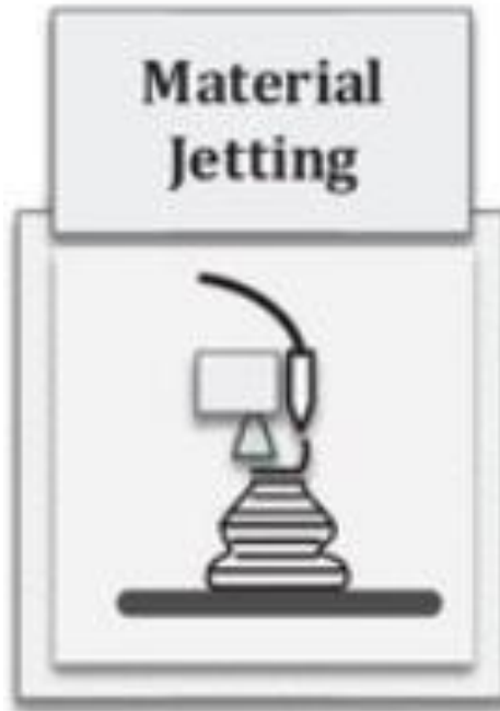
Εικόνα 1.0.3 Σχηματική Απεικόνιση Τριδιάστατης Εκτύπωσης Material Jetting
