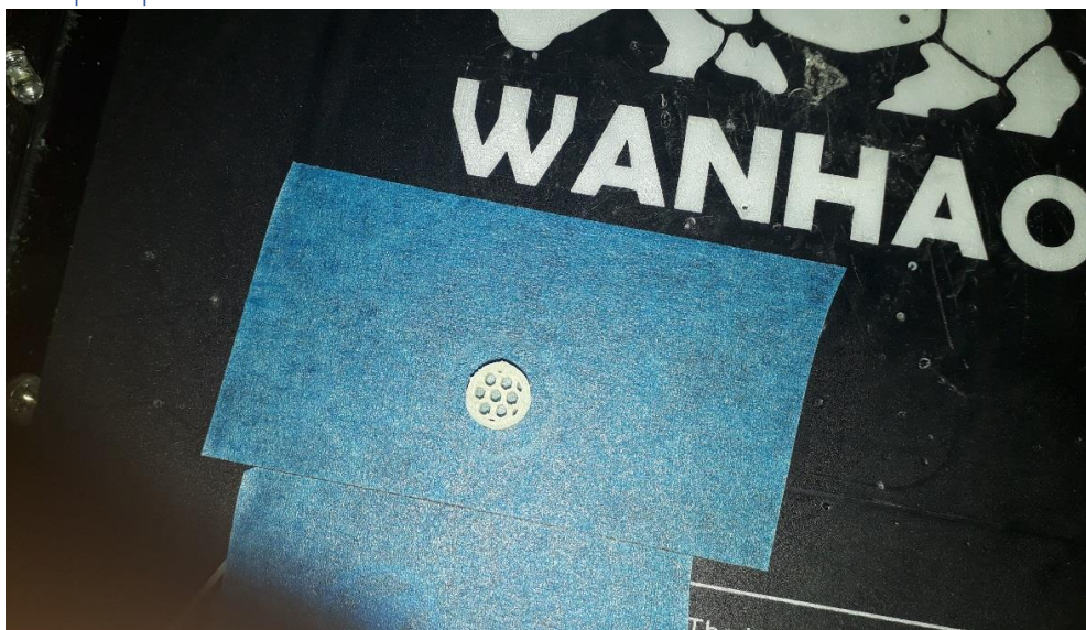
Εικόνα 5.10 Εκτυπωμένος Φορέας διαμέτρου κυψελίδας 250mm σε ανοιχτή μορφή προκειμένου να εκτιμηθεί ποιοτικά ο τρόπος πλήρωσης
