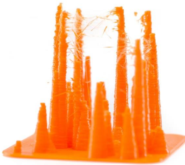
Εικόνα 4.99 Αποτέλεσμα Εκτύπωσης με stringing
