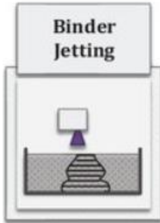
Εικόνα 1.0.2 Σχηματική Απεικόνιση Τριδιάστατης Εκτύπωσης Binder Jetting
