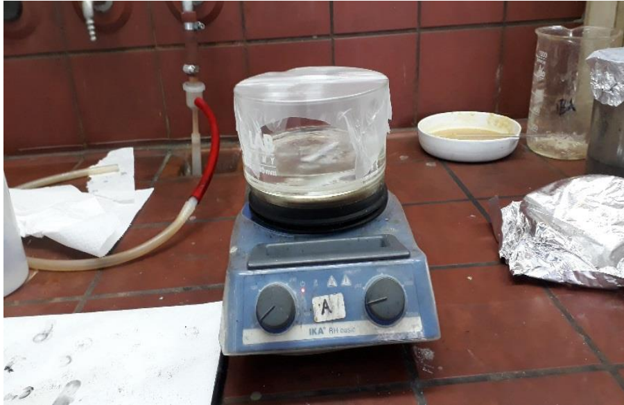
Εικόνα 5.1 Διάλυμα κουμαρίνης-αιθανόλης υπό ανάδευση με νήμα PVA
