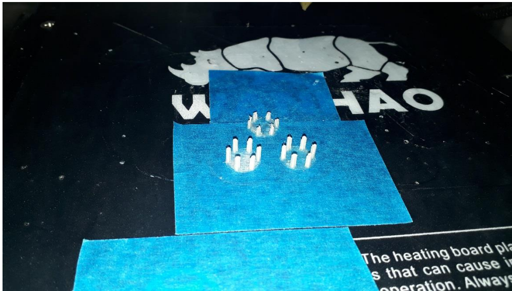
Εικόνα 5.8 Αποτέλεσμα μετά την εκτύπωση των Retraction Tests
