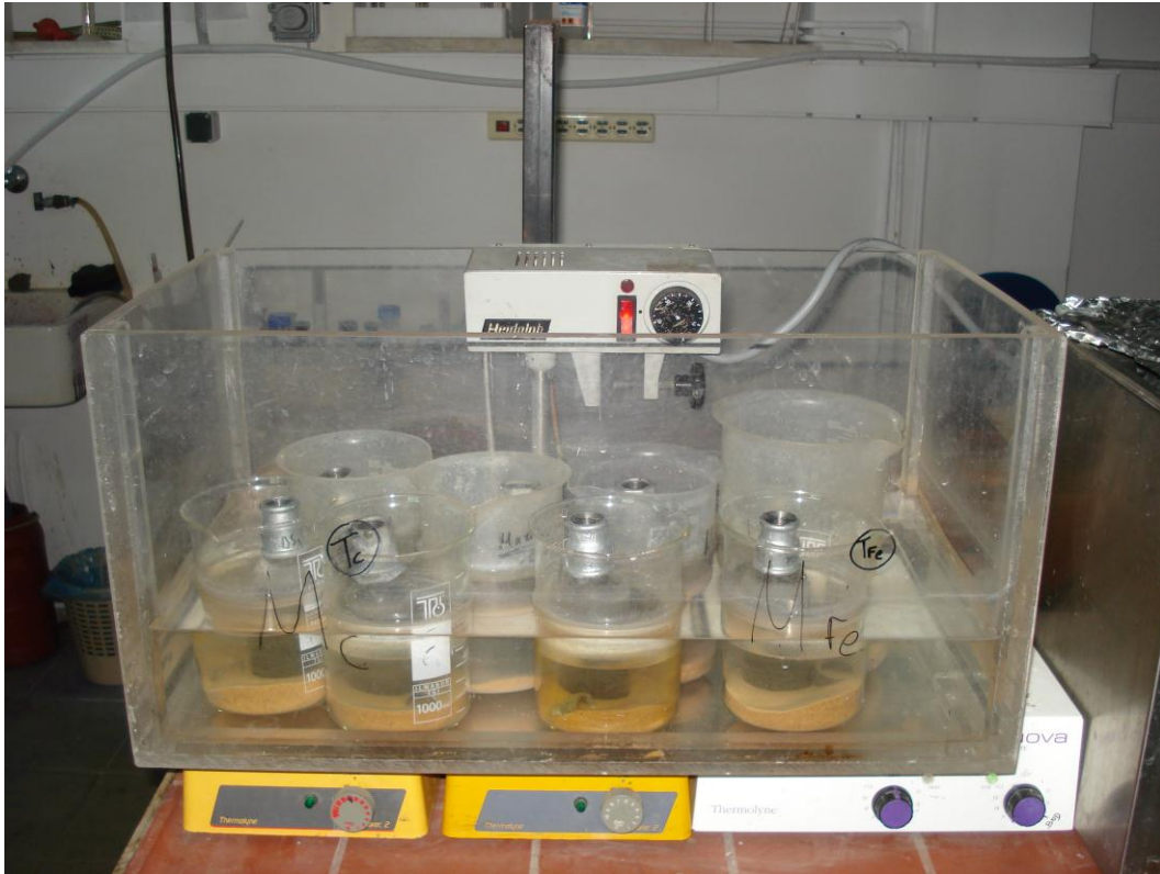
Εικόνα 3.16: Υδατόλουτρο με χωνευτές batch
