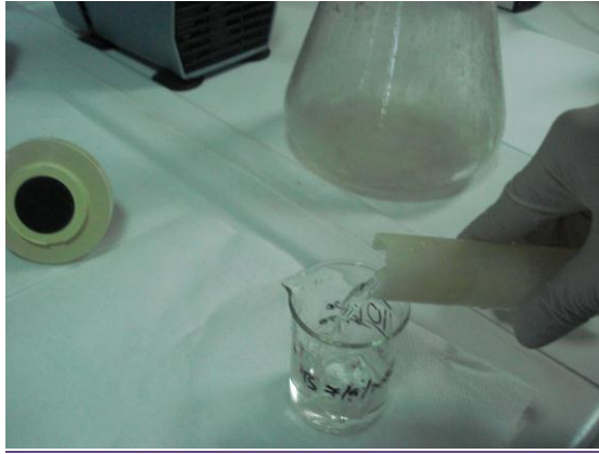
Εικόνα 3.9: Διαδικασία εξαγωγής δείγματος για τη μέτρηση του διαλυτού COD: χρήση φίλτρων GF/C, διήθηση, χρήση μεμβρανών, δεύτερη διήθηση
