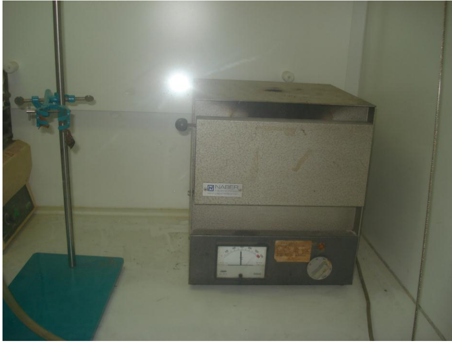
Εικόνα 3.7: Φούρνος των 550 °C για τη καύση των οργανικών στερεών
