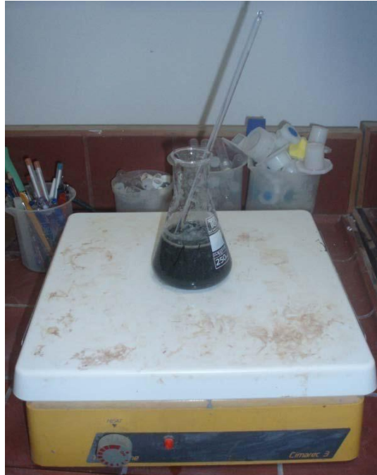
Εικόνα 3.10: Προετοιμασία δείγματος, θέρμανση στους 37°C και ανάδευση.
