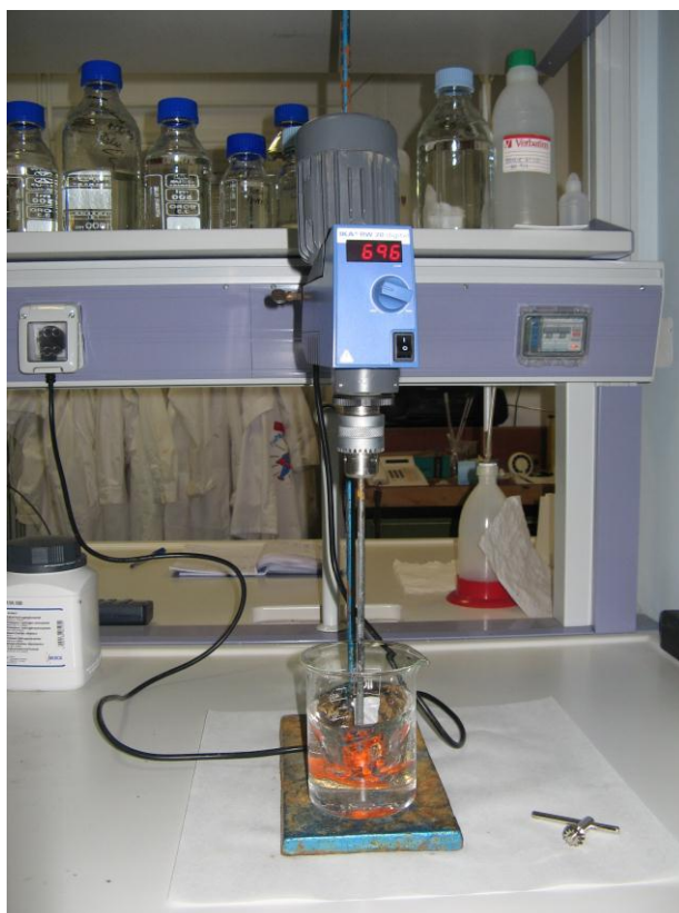
Εικόνα 3.14: Διάλυμα πολυμερούς κατά την ανάδευση
