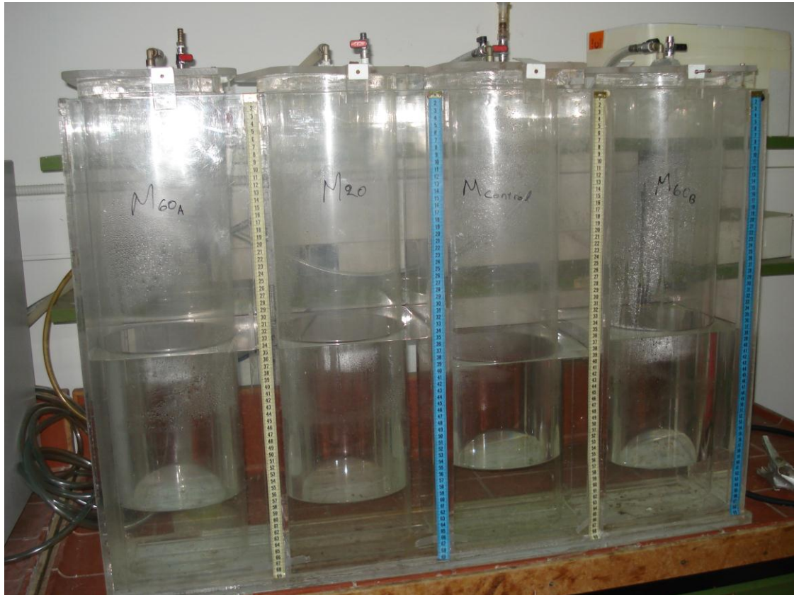
Εικόνα 3.2: Διάταξη συλλογής βιοαερίου
