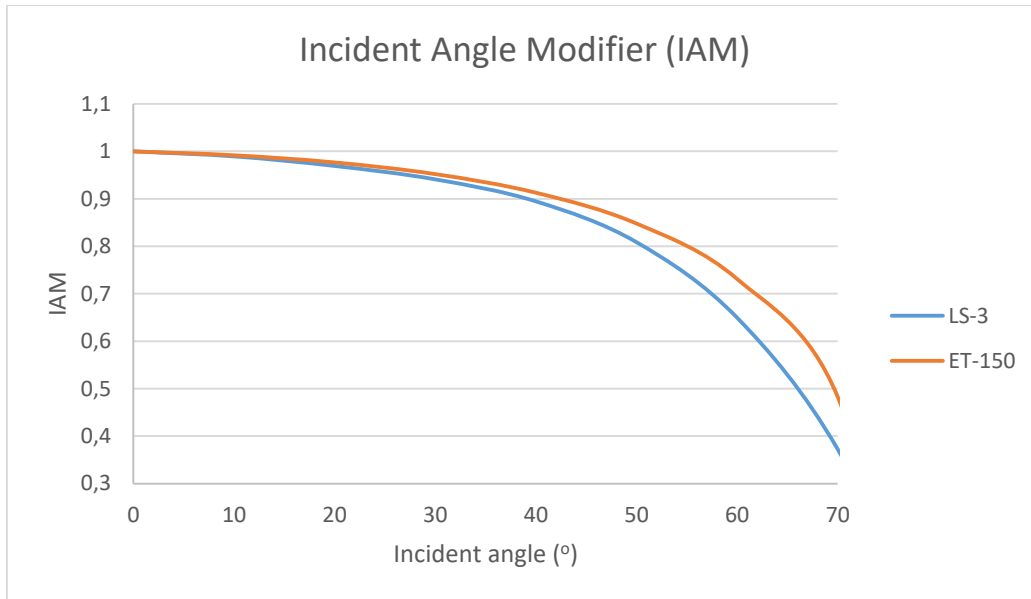
Σχήμα 3.13: Incident Angle Modifier συναρτήσεως της γωνίας πρόσπτωσης για συλλέκτη LS-3 και ET-150
