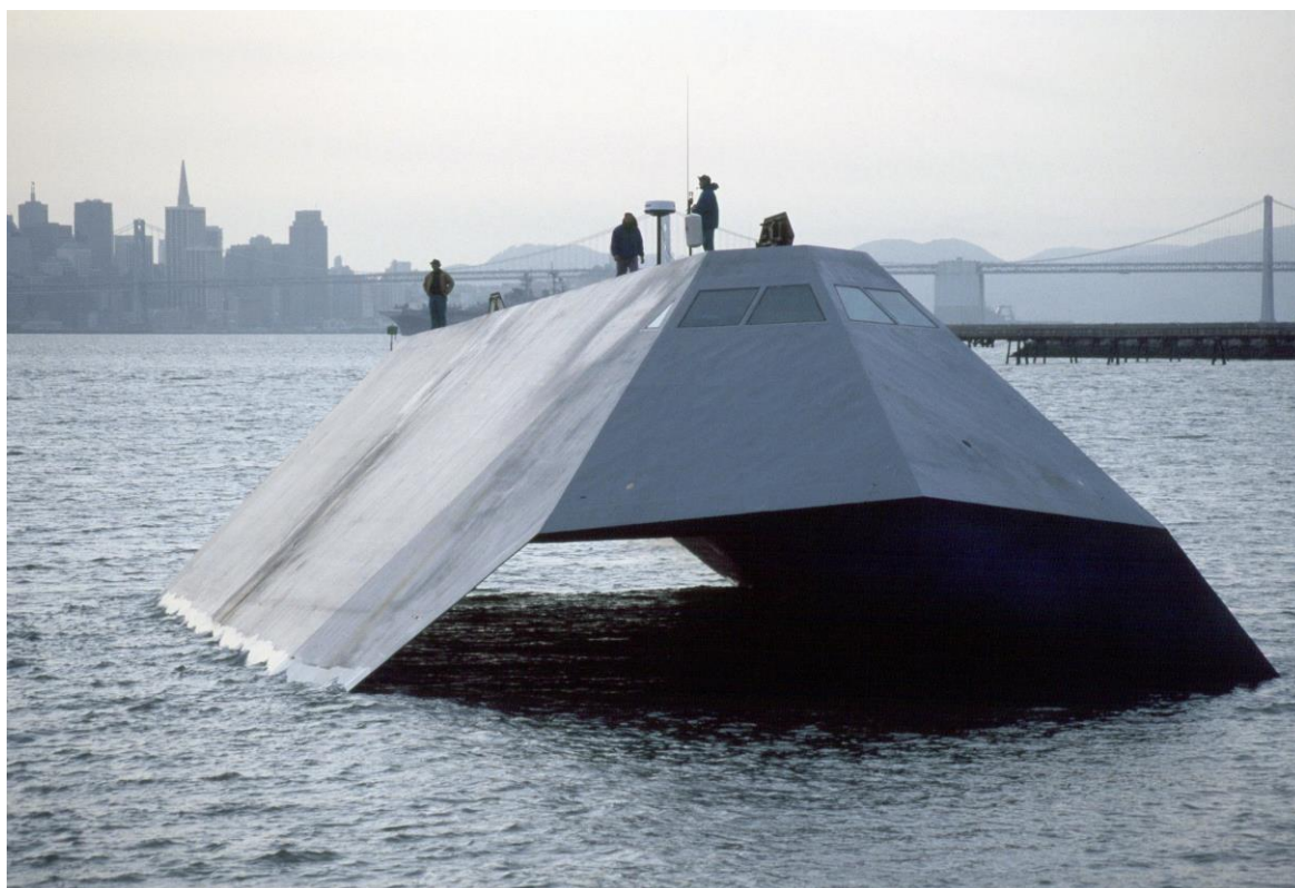
Εικόνα.5.1. Σύγχρονο πλοίο stealth καταμαράν με τεχνολογία απόκρυψης σε υλικό και αρχιτεκτονική
