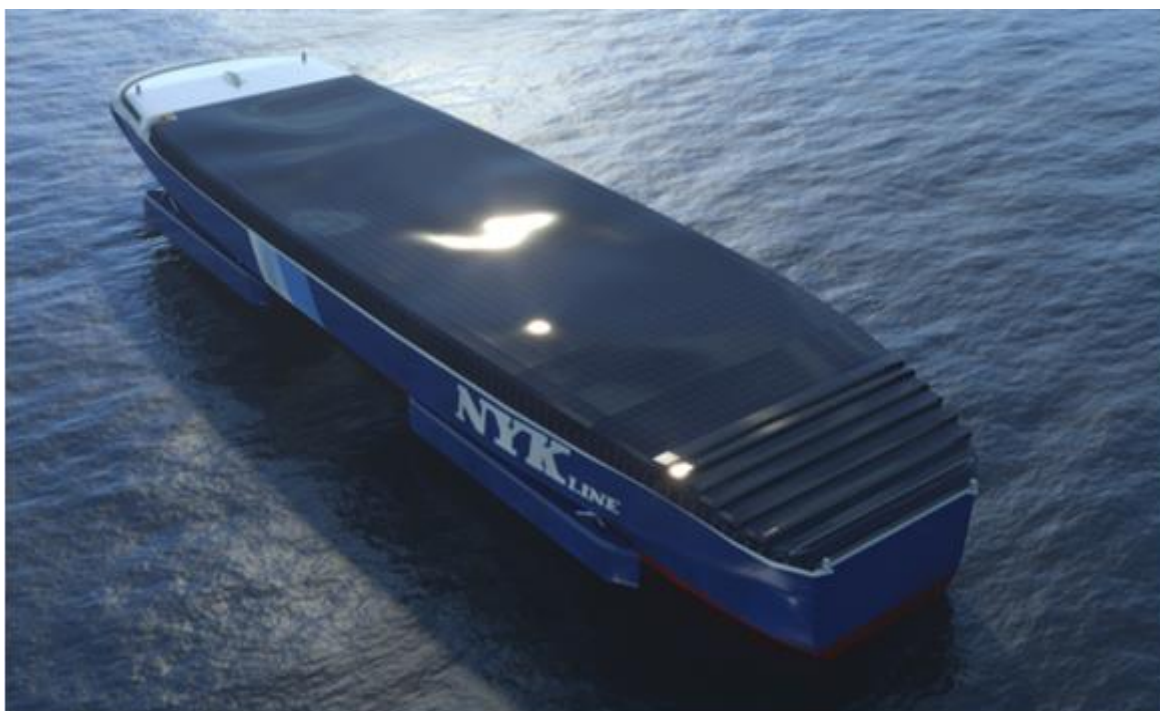
Εικόνα.4.2. Πλοίο τροφοδοτούμενο από ηλιακά φωτοσυλλεκτικά πάνελ ευρείας επιφάνειας
