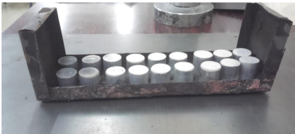
Εικόνα 3.1.ζ: Δοκίμια μετά την πυροσυσσωμάτωση στους 530°C.
