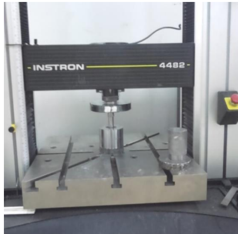
Εικόνα 3.1.δ: Μηχανή γενικής δοκιμής Instron 4482.
