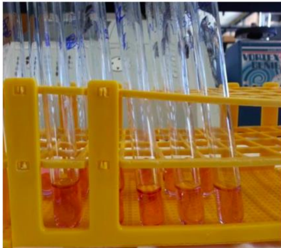
Σχήμα 4.5: Προσδιορισμός ελεύθερης γλυκόζης με τη μέθοδο GOD/PAP
