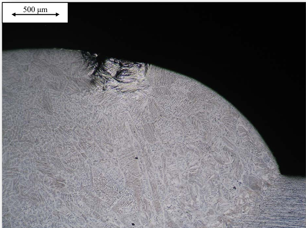
Εικόνα 60-Καπάκι συγκόλλησης ημιτελούς τήξης ,με ηλεκτρόδιο ίδιας σύστασης και 60 A ένταση ρεύματος.
