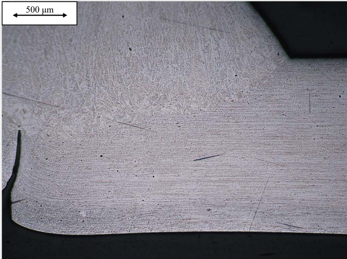
Εικόνα 69- Ατελής συγκόλληση 2. Ένταση ρευματός 60 Α και καταναλισκόμενο ηλεκτρόδιο 17-7 ΡΗ. Ελάχιστη απόσταση μεταξύ των βασικών μετάλλων .
