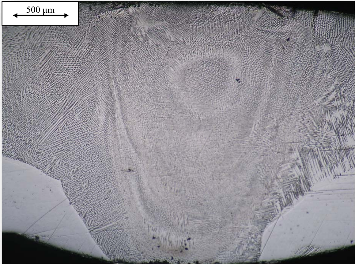
Εικόνα 97- Ζώνη τήξης του Δοκίμιου Γ.
