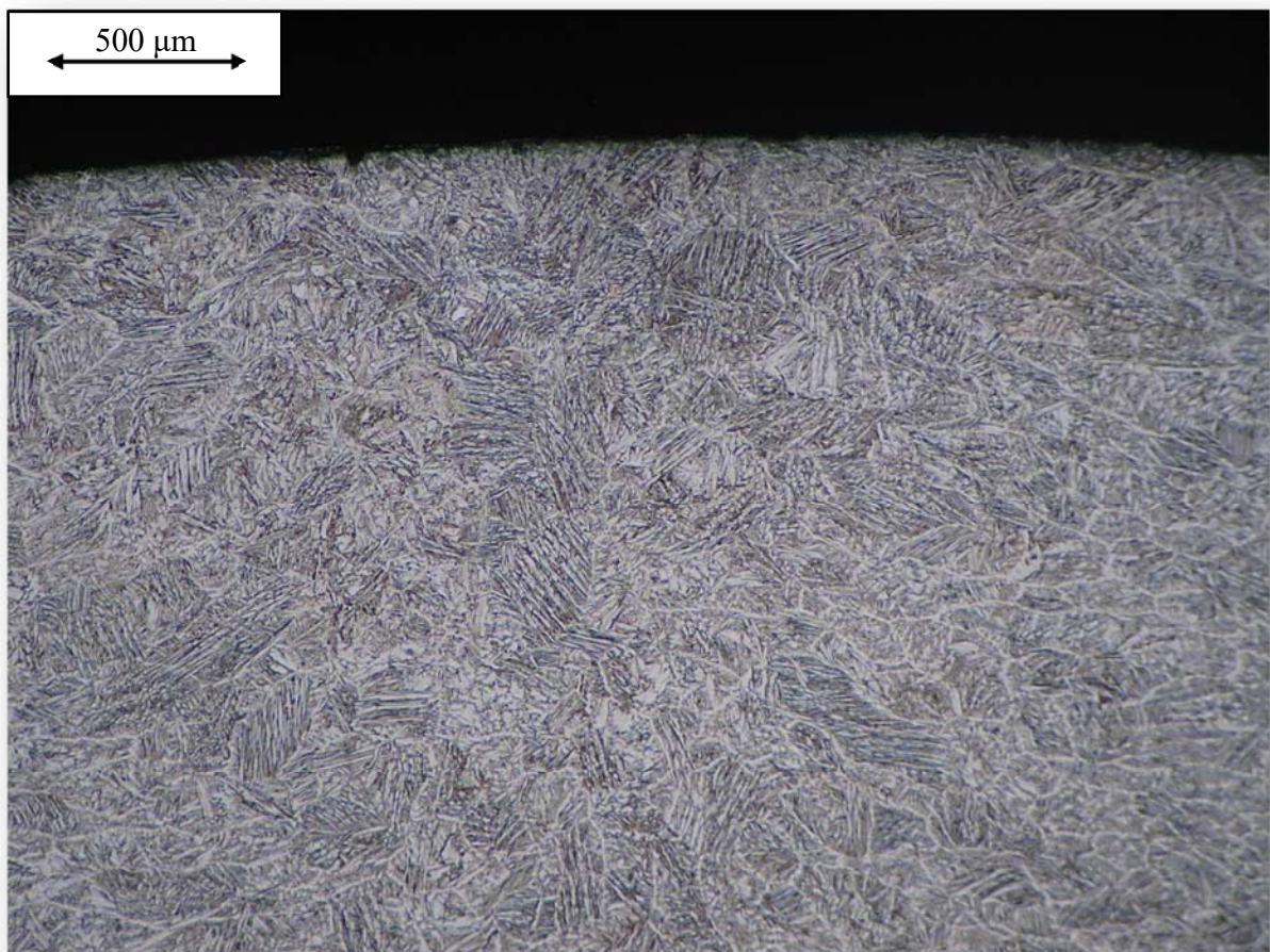
Εικόνα 91-Μικροδομή δοκίμιου Α. Παρόμοια με αυτή της πρότυπης συγκόλλησης 1.
