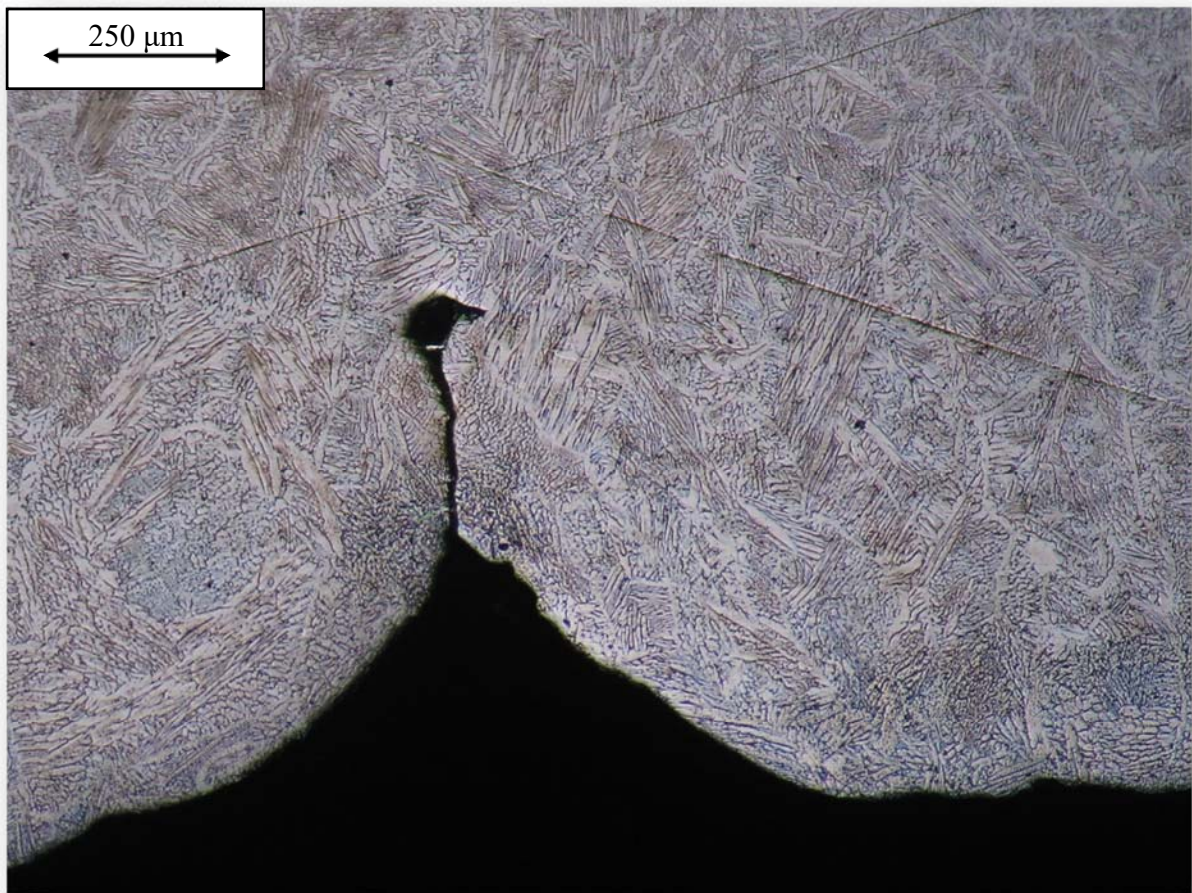
Εικόνα 67- Θερμή ρωγμάτωση σε συγκόλληση 17-7 PH ,με αυτοσχέδιο ηλεκτρόδιο ίδιας σύστασης ,άνευ backing gas ,με ένταση ρεύματος 60 A.2
