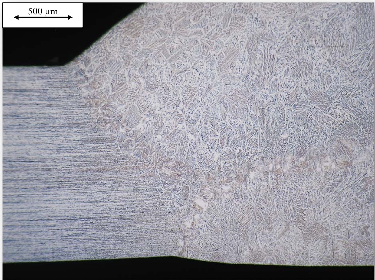
Εικόνα 71-Διπλή ραφή συγκόλλησης ,σε δοκίμιο 17-7 PH, με ηλεκτρόδιο ίδιας σύστασης ,60 A ένταση ρεύματος.
