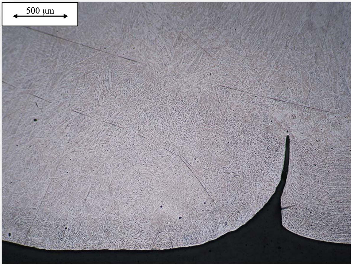
Εικόνα 70- Ατελής συγκόλληση 2. Ένταση ρευματός 60 A και καταναλισκόμενο ηλεκτρόδιο 17-7 PH. Ελάχιστη απόσταση μεταξύ των βασικών μετάλλων .
