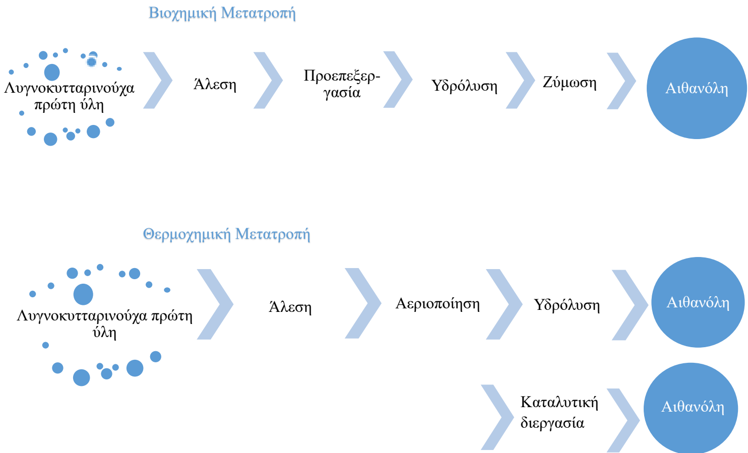
Σχήμα 2. Σχηματική απεικόνιση των διαδικασιών παραγωγής αιθανόλης από λιγνοκυτταρινούχες πρώτες ύλες
