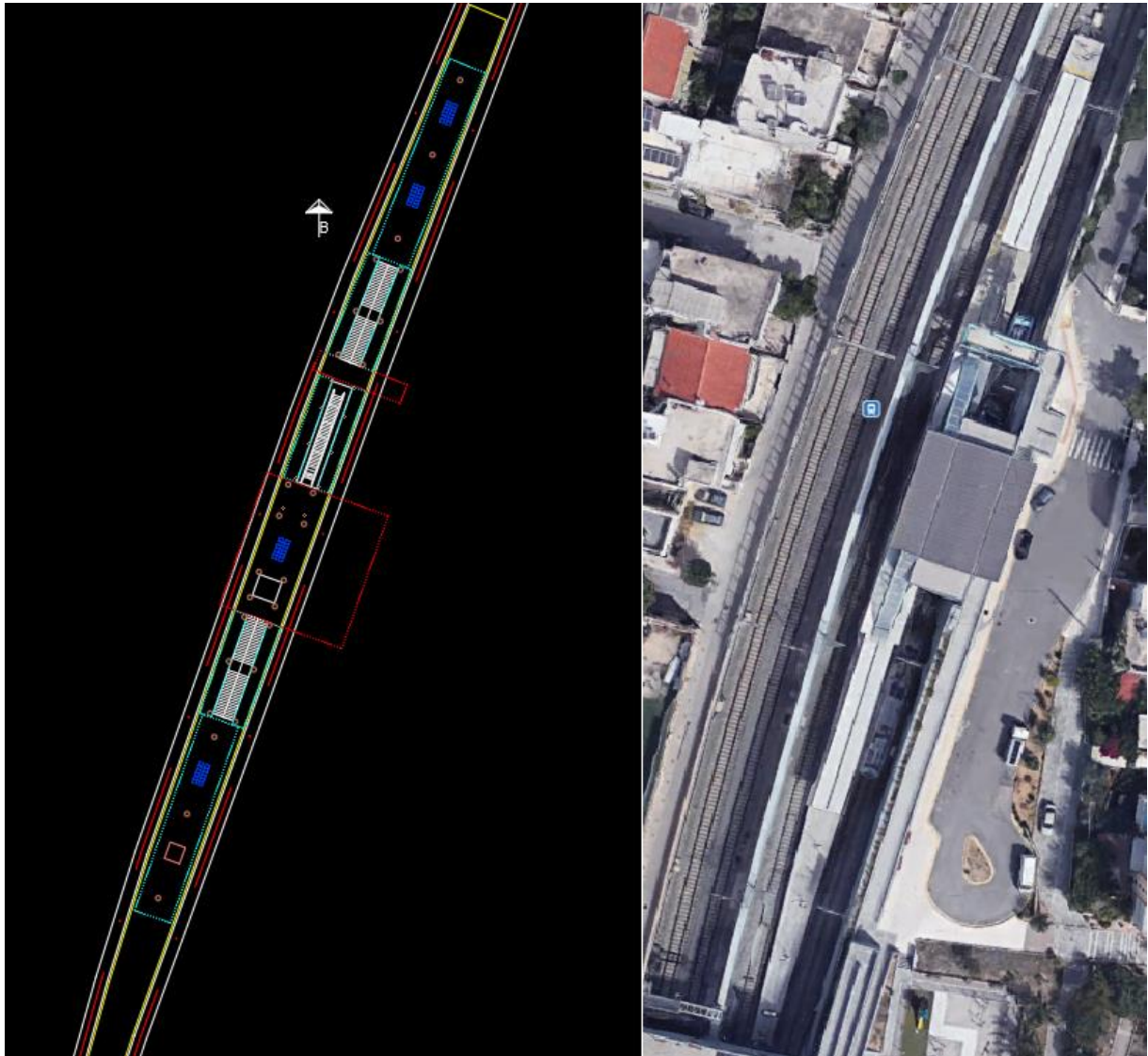
Εικόνα 2.11: Σταθμός «Πύργος Βασιλίσσης» Προαστιακού Σιδηροδρόμου, Τοπογραφική απόδοση με χρήση σχεδιαστικού προγράμματος AutoCAD, Προσανατολισμένη Διάταξη σταθμού με εικόνα από Google Earth
