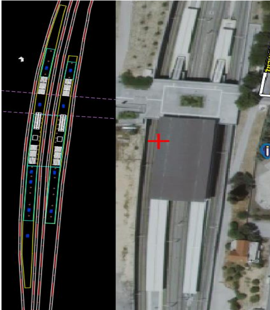
Εικόνα 2.9: Σταθμός «Άγιοι Ανάργυροι» Προαστιακού Σιδηροδρόμου, Τοπογραφική απόδοση με χρήση σχεδιαστικού προγράμματος AutoCAD, Προσανατολισμένη Διάταξη σταθμού με εικόνα από Google Earth
