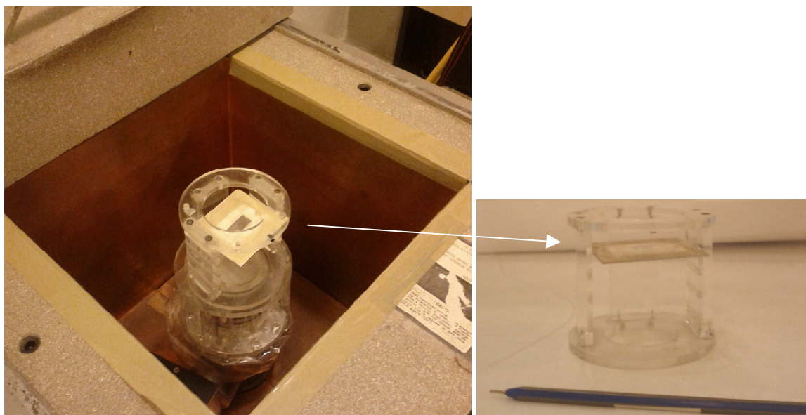
Σχήμα 5.2 : Πρότυπη σημειακή πηγή ^{60}\text{Co} σε απόσταση 78mm από την ανιχνευτική διάταξη HPGe του Ε.Π.Τ.-Ε.Μ.Π.
