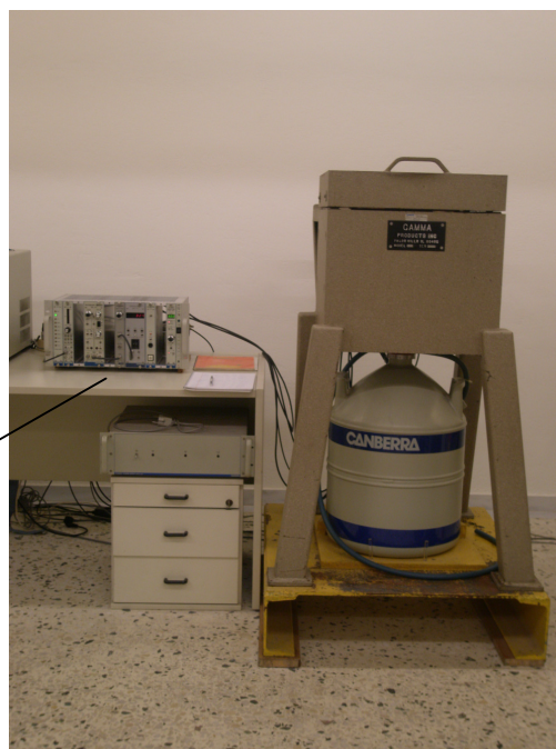
Σχήμα 2.4 : Ανιχνευτική διάταξη με ανιχνευτή HPGe του Ε.Π.Τ.-Ε.Μ.Π.
