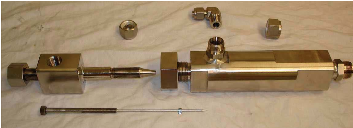
Εικόνα 3-9 Απεικόνιση Ejector (Εκτοξευτή) [44]
