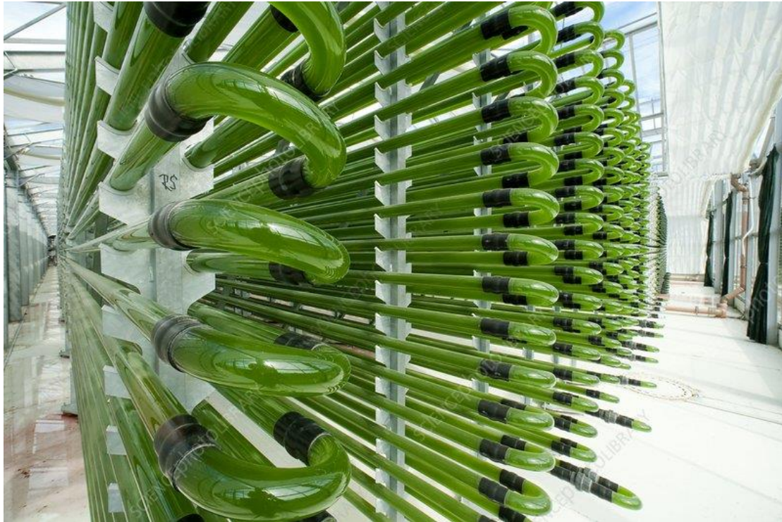
Σχήμα 3.3: Αυλωτός φωτοβιοαντιδραστήρας για την παραγωγή υψηλής αξίας συμπληρωμάτων διατροφής από μικροφύκη (IGV-Biotech). [13]
