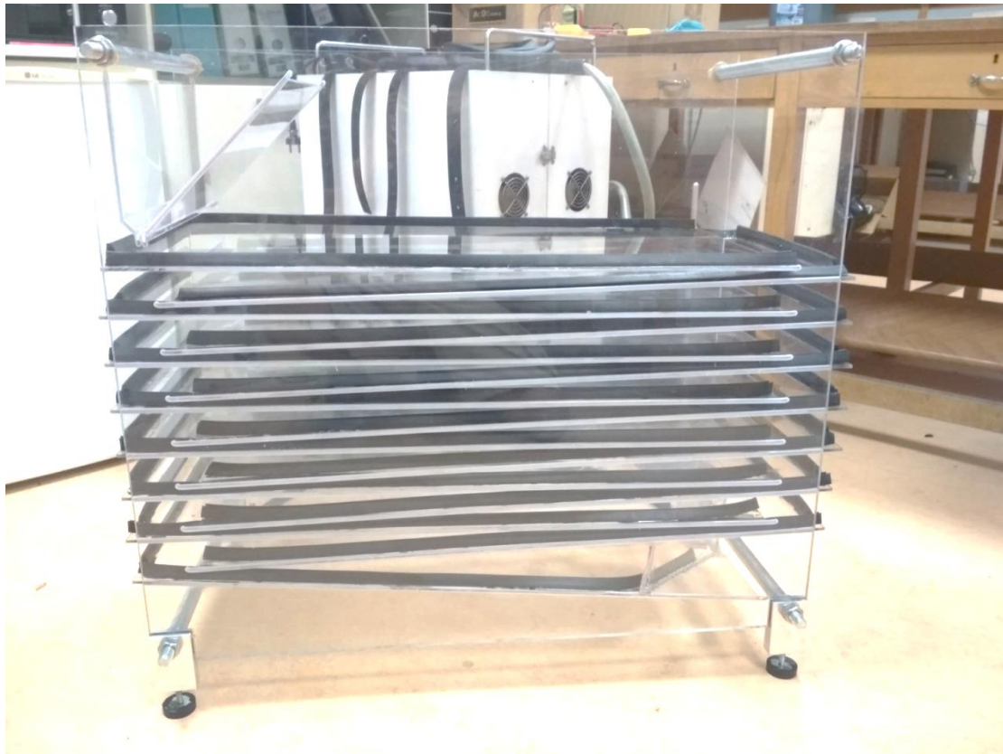
Σχήμα 6.33: Πλαϊνή όψη αντιδραστήρα μετά την στεγανοποίηση
