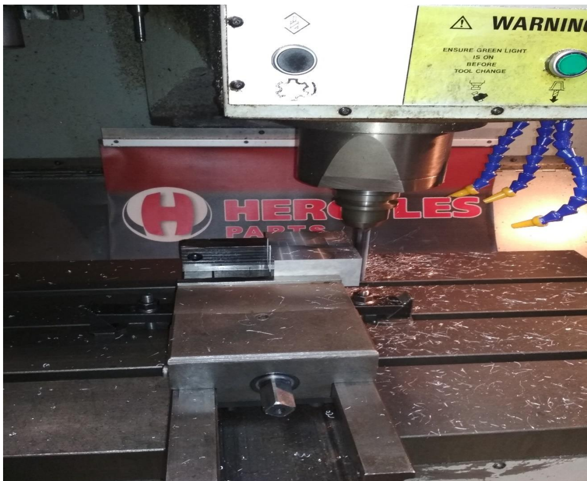
Σχήμα 6.26: Βάση ποδιών αντιδραστήρα από αλουμίνιο
