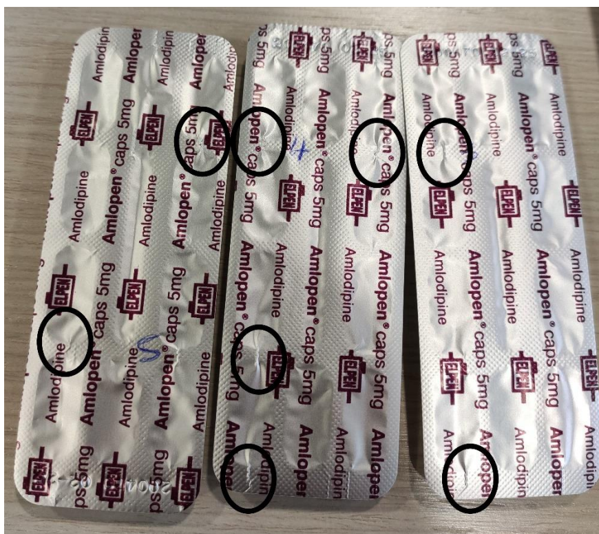
Σχήμα 4.21: Blister με συρίγγια μεταξύ των φωλιών.
