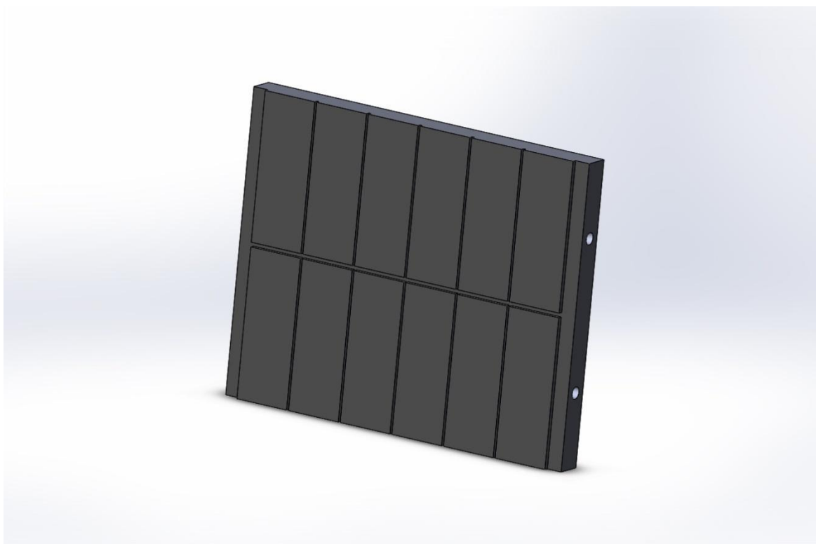
Σχήμα 4.3: Η πλάκα προθέρμανσης με μοτίβο δύο σειρές των έξι blister.
