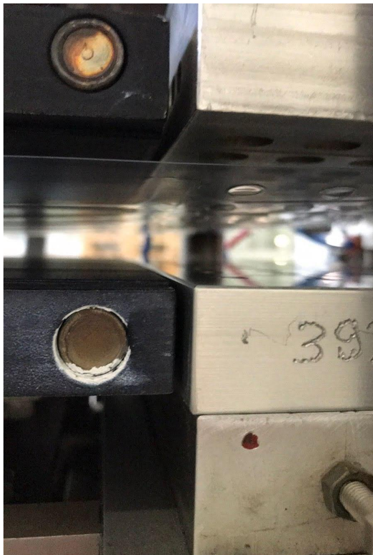
Σχήμα 4.5 Αριστερά η πάνω και κάτω πλάκα προθέρμανσης με την επίστρωση τεφλόν και τις αντιστάσεις. Δεξιά η πάνω και κάτω πλάκα διαμόρφωσης.
