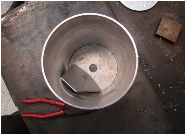
Δοχείο λιπαντικού κατά την κατασκευή
