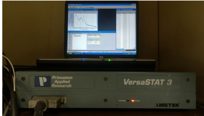
Εικόνα 2.9. Ποτενσιοστάτης Ametek Versastat 3, με τις τιμές καθοδικού δυναμικού να λαμβάνονται ανά δευτερόλεπτο.
