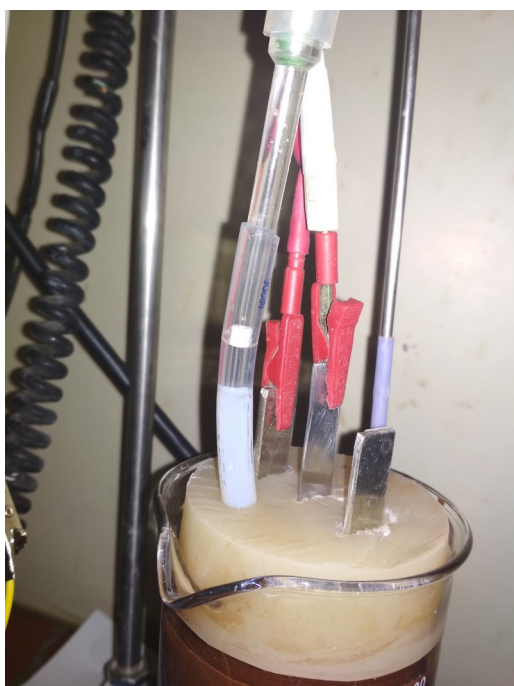
Εικόνα 2.4. Φωτογραφία κατασκευής της πειραματικής διάταξης του ηλεκτρολυτικού κελιού πριν την σύνδεση με τη πηγή.
