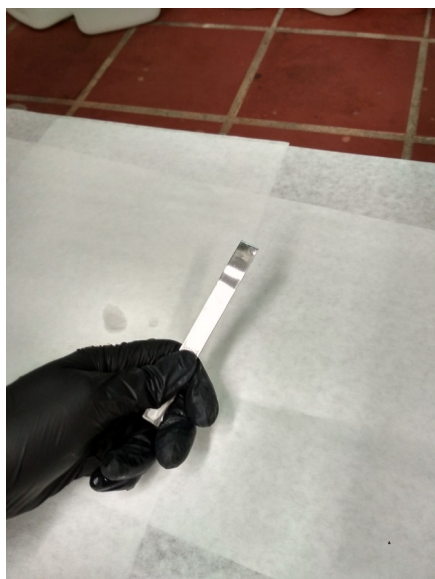
Εικόνα 2.2. Καθοδικό ηλεκτρόδιο ανοξειδωτου χάλυβα μετά από λείανση, έκπλυση και ζύγιση.
