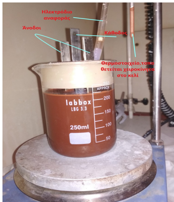
Εικόνα 1.9. Πειραματική διάταξη κελιού με παράλληλα επίπεδα ηλεκτρόδια σε σειρά (CE-WE-CE vs RE).
