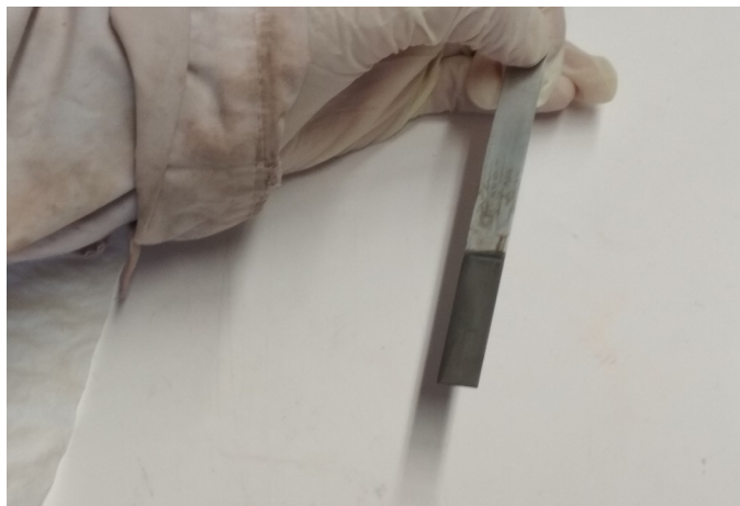
Εικόνα 2.11. Καθοδικό ηλεκτρόδιο μετά από ξήρανση και ζύγιση.
