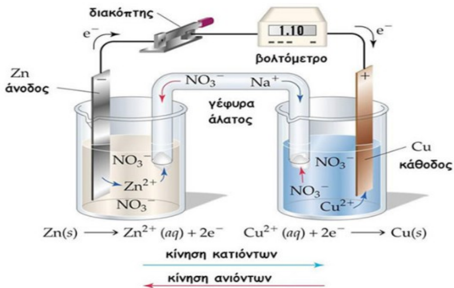
Εικόνα 1.7. Αναπαράσταση γαλβανικού στοιχείου Daniell. Το στοιχείο αποτελείται από δύο κελιά συνδεδεμένα με μία γέφυρα άλατος για τη μεταφορά ιόντων, καθώς παίρνονται τιμές δυναμικού από βολτόμετρο. [79]
