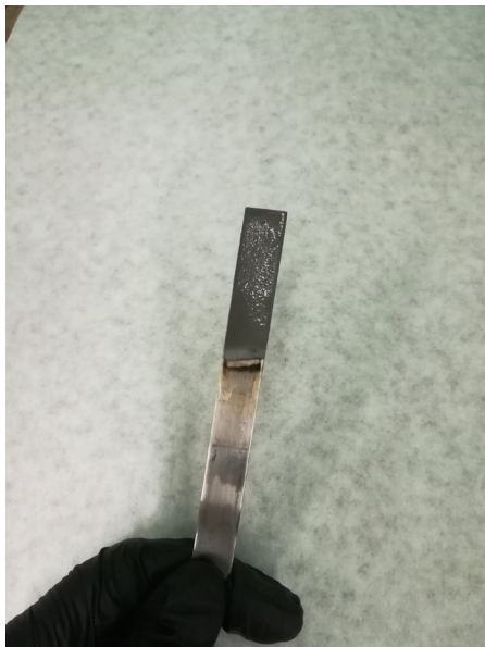
Εικόνα 2.10. Καθοδικό ηλεκτρόδιο μετά τη λήξη της πειραματικής διαδικασίας.
