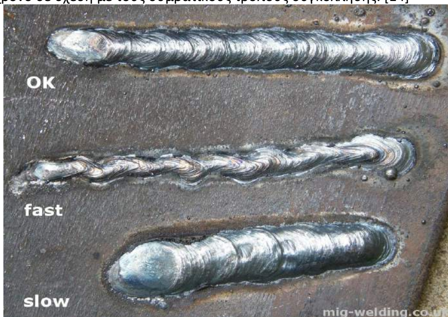
Εικόνα 3-3: Μορφή συγκόλλησης για διάφορες ταχύτητες συγκόλλησης [14]
