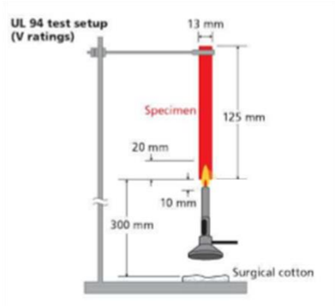
Σχήμα 3.6: Πειραματική διάταξη UL94 Test [7]
