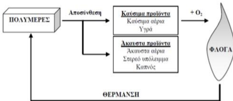
Σχήμα 2.1: Σχηματική αναπαράσταση του μηχανισμού καύσης πολυμερών [4]
