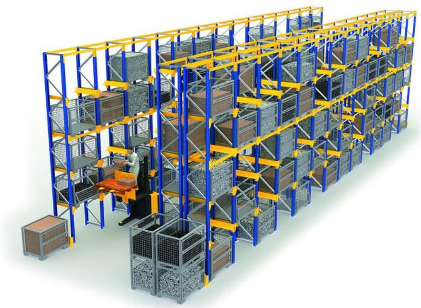
Εικόνα 36 Στατικό σύστημα ραφιών μεμονωμένης θέσης (Πηγή: 40)
