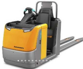
Εικόνα 47 Μηχάνημα συλλογής παραγγελιών οριζόντιας μεταφοράς (Πηγή: Error! Bookmark not defined.)
