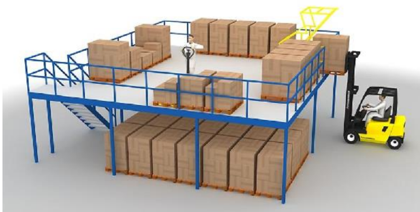
Εικόνα 40 Υπερυψωμένος χώρος (πατάρι) αποθήκευσης (Πηγή: Error! Bookmark not defined.)
