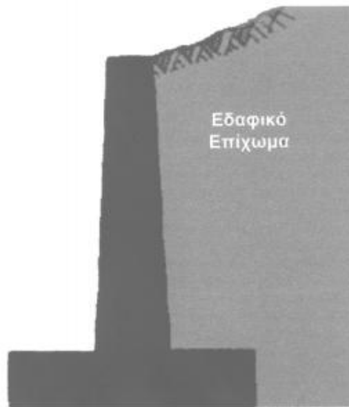
Εικόνα 3.5: Τοίχος αντιστήριξης ανεστραμένου T (Σταθοπούλου, 2005)
