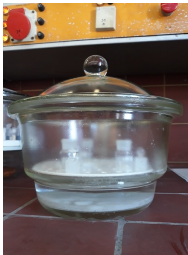
Εικόνα 3.9: Θάλαμος που περιέχει κορεσμένο υδατικό διάλυμα νιτρικού καλίου και βρίσκεται σε θερμοκρασία 27-28°C. Το συγκεκριμένο διάλυμα παρέχει περιβάλλον σχετικής υγρασίας 95% RH σε αυτήν τη θερμοκρασία.
