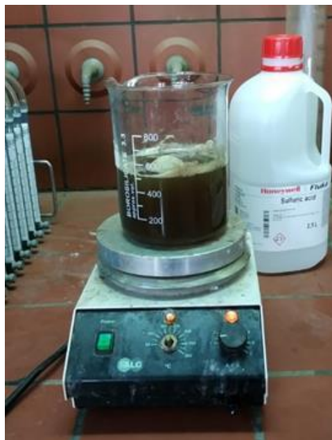
Εικόνα 9: Δείγμα στραγγισμάτων υπό ανάδευση κατά την επεξεργασία Fenton
