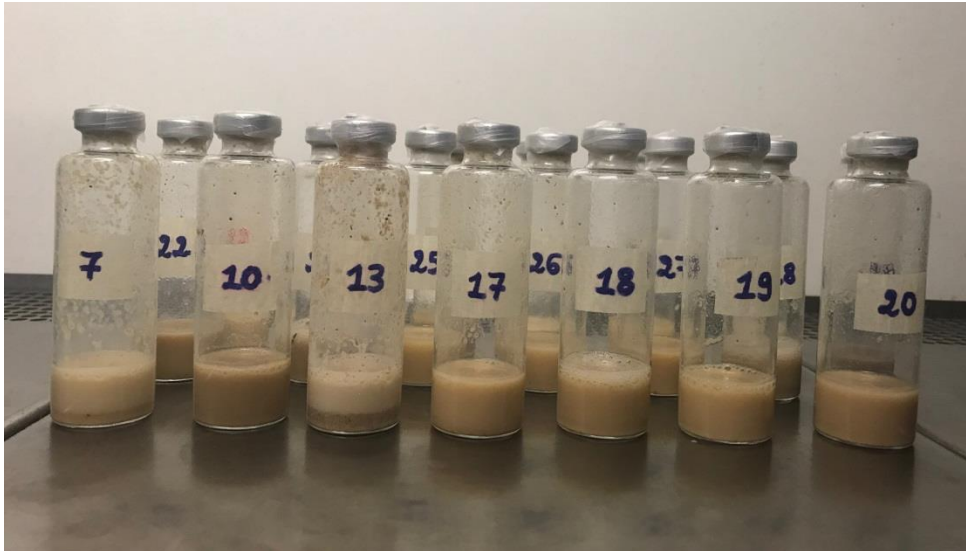
Εικόνα 3: Γυάλινες φιάλες αναερόβιας καλλιέργειας μετά την διεξαγωγή του πειράματος SSF με τον L. delbrueckii .
