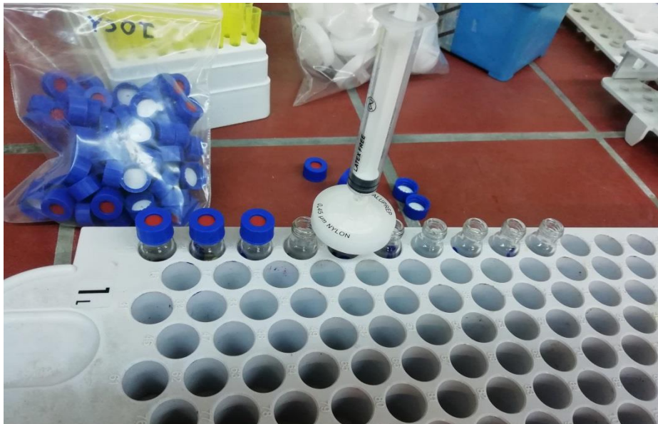
Εικόνα 4: Διαδικασία προετοιμασίας των δειγμάτων για την εισαγωγή στην υγρή χρωματογραφία.
