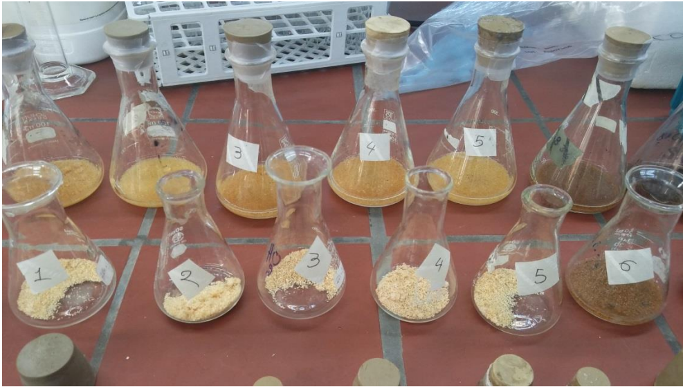
Εικόνα 1: Κωνικές φιάλες πριν την διεξαγωγή του πειράματος ενζυμικής υδρόλυσης. Η μπροστά σειρά αποτελεί τα δείγματα βιομάζας χωρίς το μέσο επώασης.
