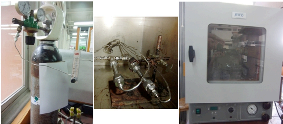
Σχήμα 41: Ροόμετρο μπίλιας συνδεδεμένο στη φιάλη φέροντος αερίου αζώτου(αριστερά). Το ροόμετρο διατηρείται σε κάθετη θέση για να είναι ενδεικτική η μέτρηση. Σύστημα αντιδραστήρων τοποθετημένων μέσα στο φούρνο (κέντρο). Φούρνος μέσα στον οποίο έγινε ο ΠΣΚ (δεξιά)
