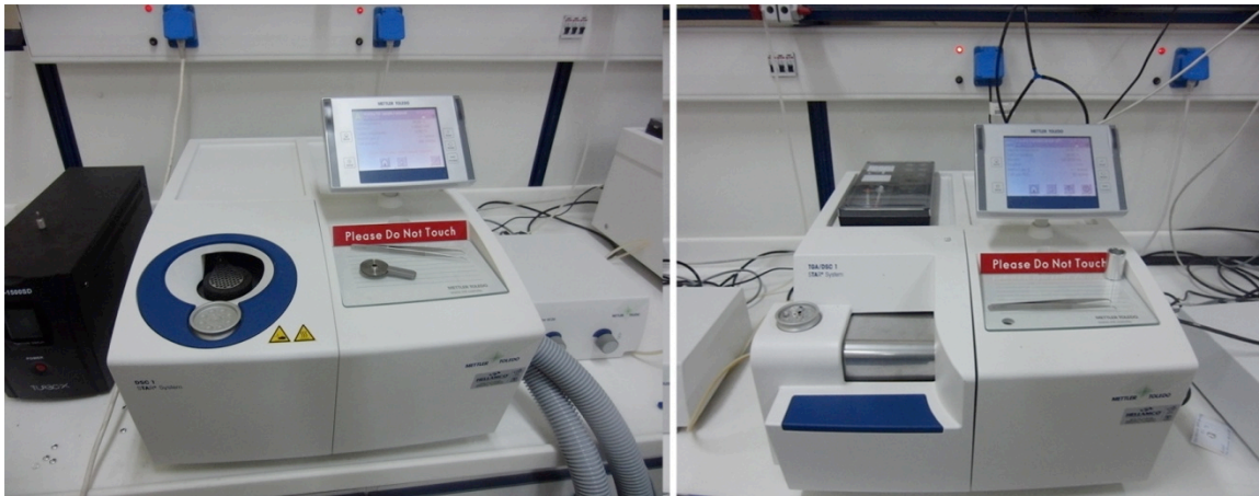
Σχήμα 45: Συσκευή διαφορικής θερμοδομετρίας σάρωσης STAR DSC (αριστερά) και συσκευή θερμοσταθμικής ανάλυσης TGA (δεξιά) (Mettler Inc.) του Τομέα IV της Σχολής Χημικών Μηχανικών Ε.Μ.Π.
