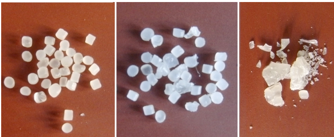
Σχήμα 55: Εικόνα πελεττών ενώ έχουν υποστεί ελάχιστη επίτηξη (+)(αριστερά), με αλλοίωση των ακμών τους(++) (κέντρο) και ως συσσωμάτωμα (+++)(δεξιά)
