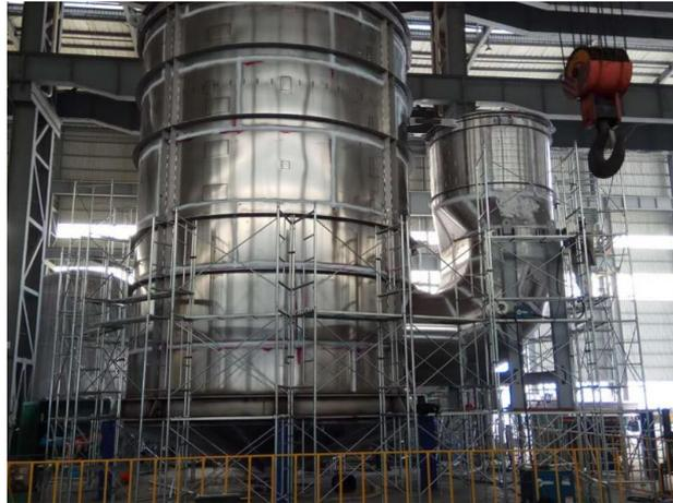
Εικόνα 22: Σύστημα SOx κατασκευαστή -12 [Γ10]
