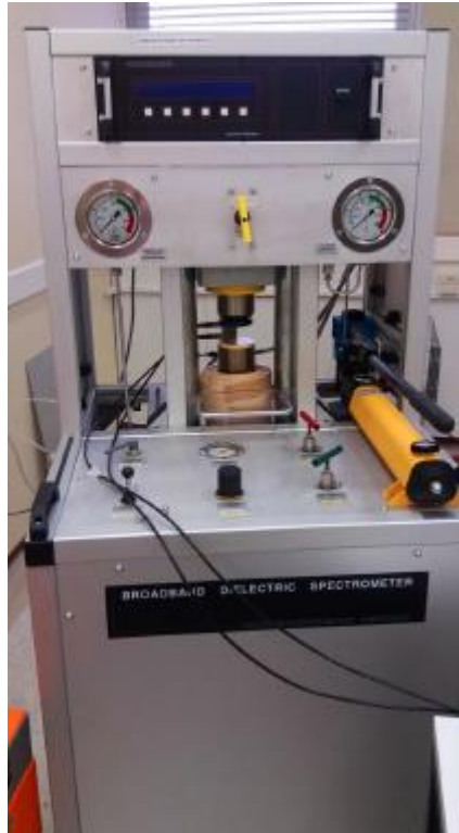
Εικόνα 6.2.3.1 Το σύστημα High Pressure BDS της εταιρείας Novocontrol, στο εργαστήριο Ευρυζωνικής Διηλεκτρικής Φασματοσκοπίας του Εθνικού και Καποδιστριακού Πανεπιστημίου Αθηνών
