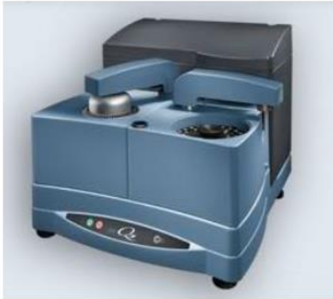
Σχήμα 6.2.3 Συσκευή DSCQ20 της εταιρίας TA Instruments(αριστερά). Καψίδια από αλουμίνιο τοποθετημένα εντός του φούρνου (δεξιά).
