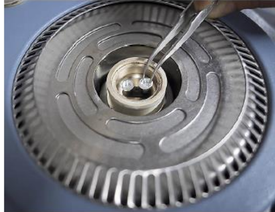
Σχήμα 6.2.3 Συσκευή DSCQ20 της εταιρίας TA Instruments(αριστερά). Καψίδια από αλουμίνιο τοποθετημένα εντός του φούρνου (δεξιά).
