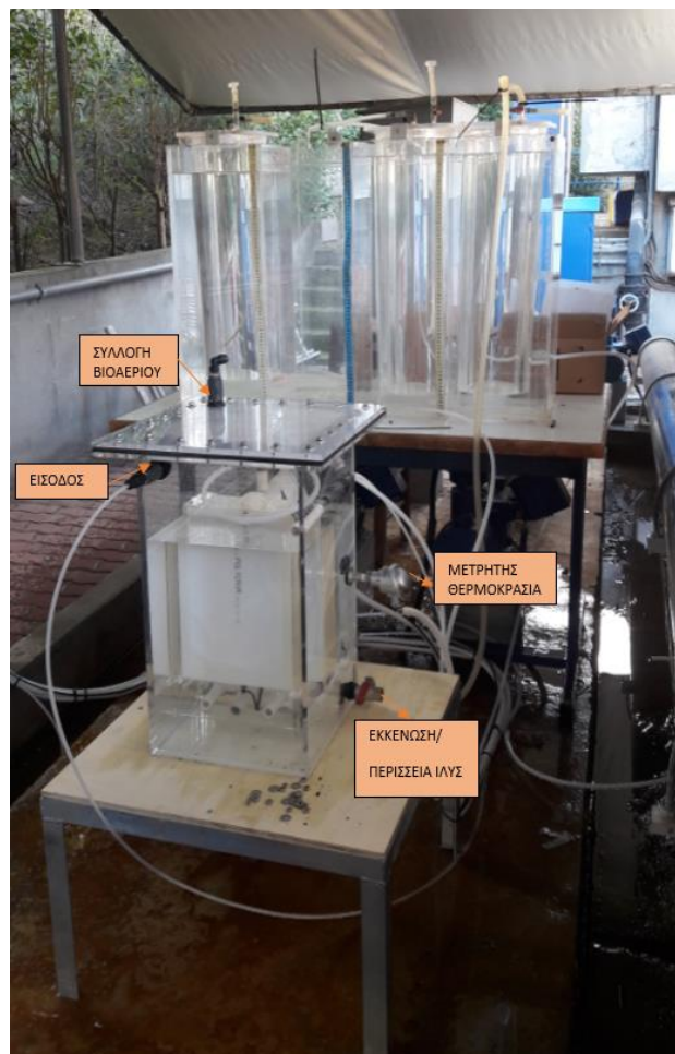
Εικόνα 3.1: Πιλοτικός αντιδραστήρας AnMBR, ΕΥΔΑΠ Μεταμόρφωσης
