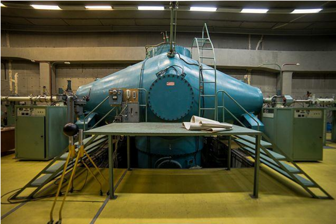
Εικόνα 2.1: Ο επιταχυντής Tandem 5.5 MV του Ινστιτούτου Πυρηνικής και Σωματιδιακής Φυσικής Ε.Κ.Ε.Φ.Ε. “Δημόκριτος”
