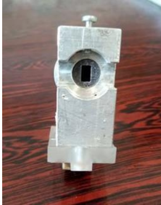
Εικόνα 2.5: κάθετη σχισμή αλουμινίου (slit) τοποθετημένη στην βάση στήριξης του ανιχνευτή.
