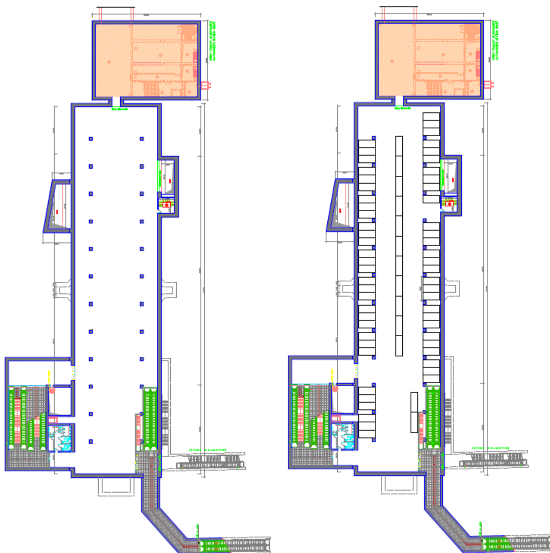
Σχήματα 4-7 , Κάτοψη του επιπέδου -1 του σταθμού «Αγία Παρασκευή», Πηγή:Μπαϊρακτάρης Δ. και Συνεργάτες. Πιθανός τρόπος χωροθέτησης των θέσεων στάθμευσης,
