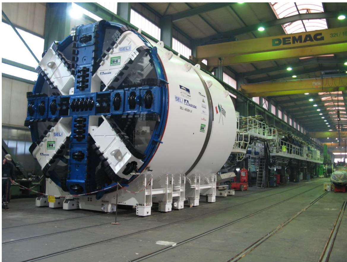
Εικόνα 4-5, Κοπτική κεφαλή EPB, Πηγή: Αττικό Μετρό
