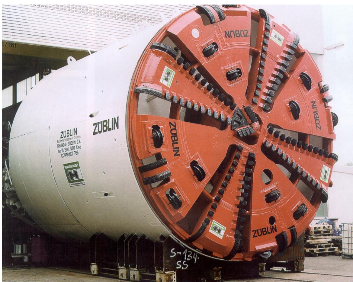
Εικόνα 4-7, Κοπτική κεφαλή και ασπίδα EPB Shield, Πηγή: Αττικό Μετρό
