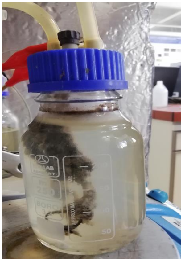
Εικόνα 5. Ανεπτυγμένο βιοφίλμ στο ηλεκτρόδιο ανόδου.
