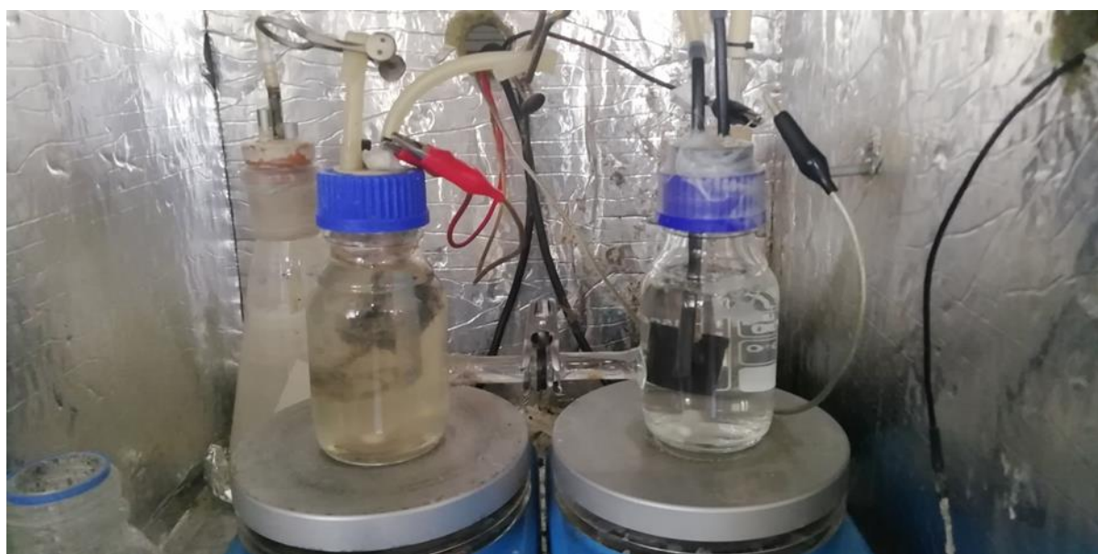
Εικόνα 4. Η MKK δύο θαλάμων που χρησιμοποιήθηκε για τα πειράματα.
