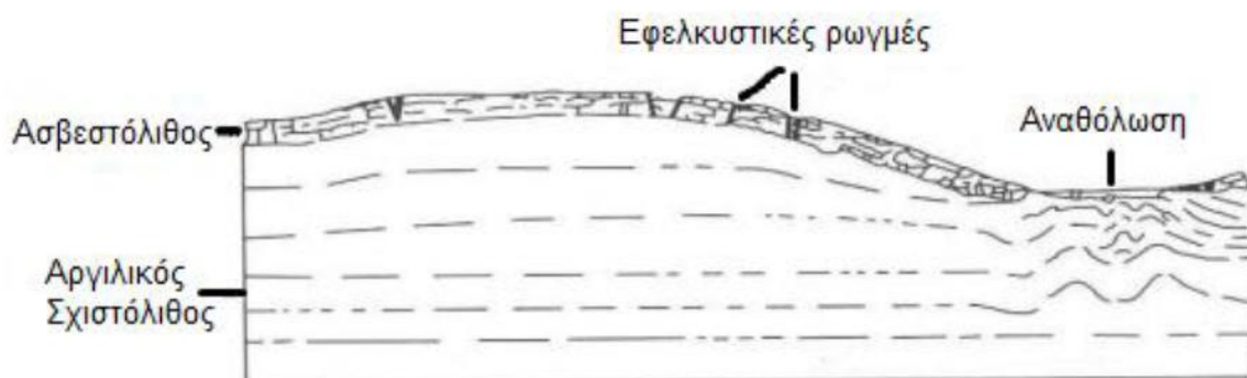
Σχήμα 7: Σύνθετη ολίσθηση, πλευρική εξάπλωση ασβεστόλιθων και αναθόλωση υποκείμενων αργιλικών σχιστόλιθων
