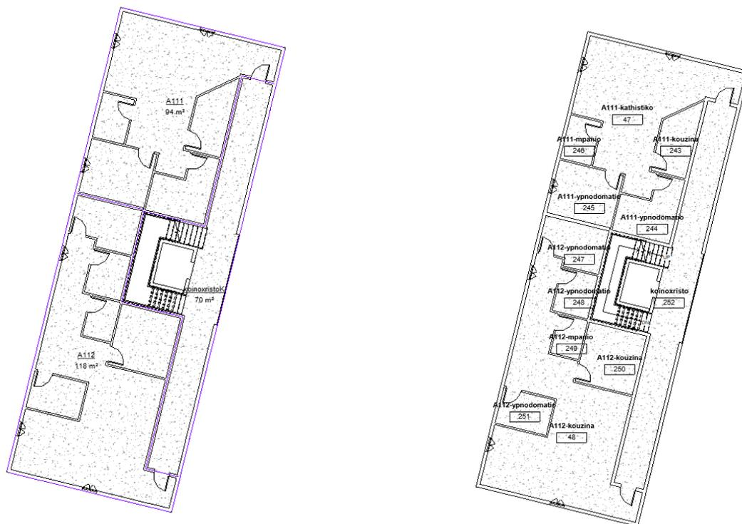
Εικόνα 44 Κάτοψη δέκατου ορόφου μόνο τα διαμερίσματα ( Area plans ( Gross Building ), Κάτοψη δέκατου ορόφου με τους εσωτερικούς χώρους ( Floor Plan )
