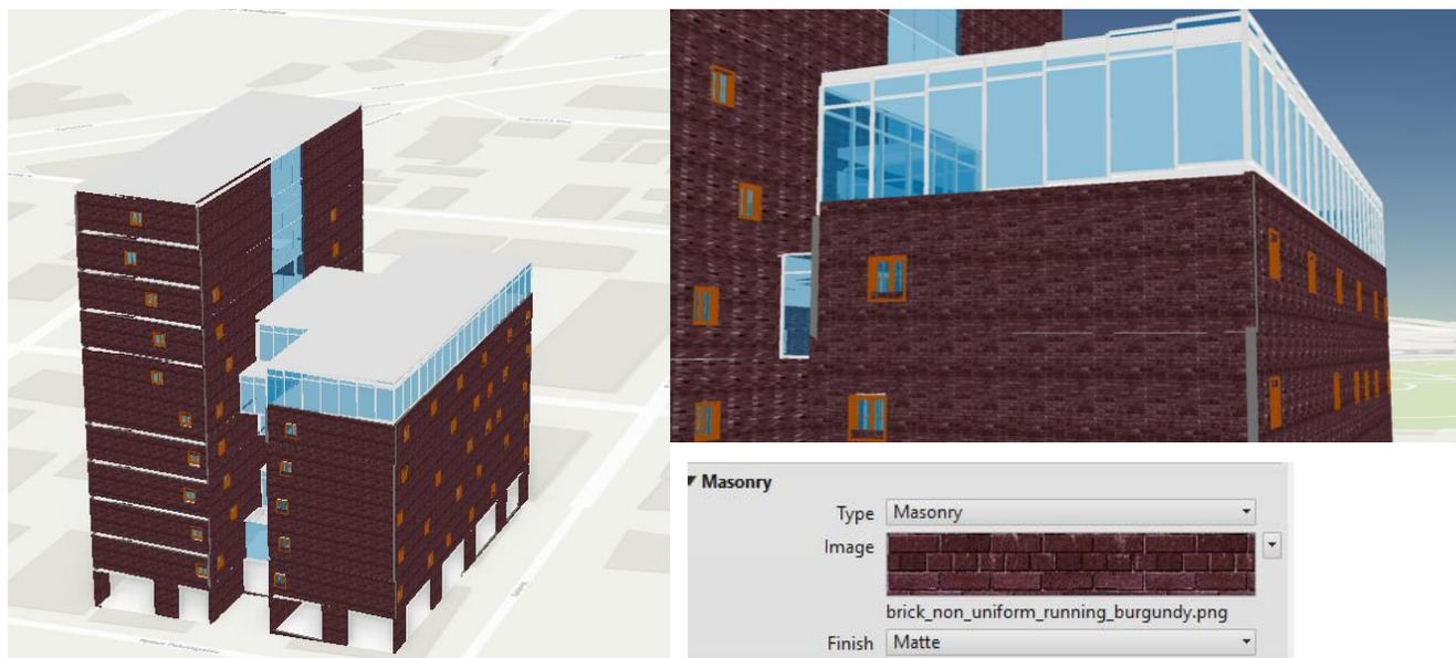
Εικόνα 71: Εισαγωγή μοντέλου στο software ArcGIS Pro από αρχείο .rvt , με περισσότερη εξωτερική λεπτομέρεια μέσω του εργαλείου BIMFile to Geodatabase και σύγκριση με το είδος τοιχοποιίας που χρησιμοποιήθηκε στο πρόγραμμα Revit
