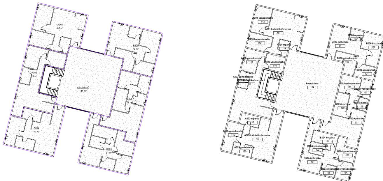
Εικόνα 37: Κάτοψη τρίτου ορόφου μόνο τα διαμερίσματα ( Area plans ( Gross Building ) , Κάτοψη τρίτου ορόφου με τους εσωτερικούς χώρους ( Floor Plan )
