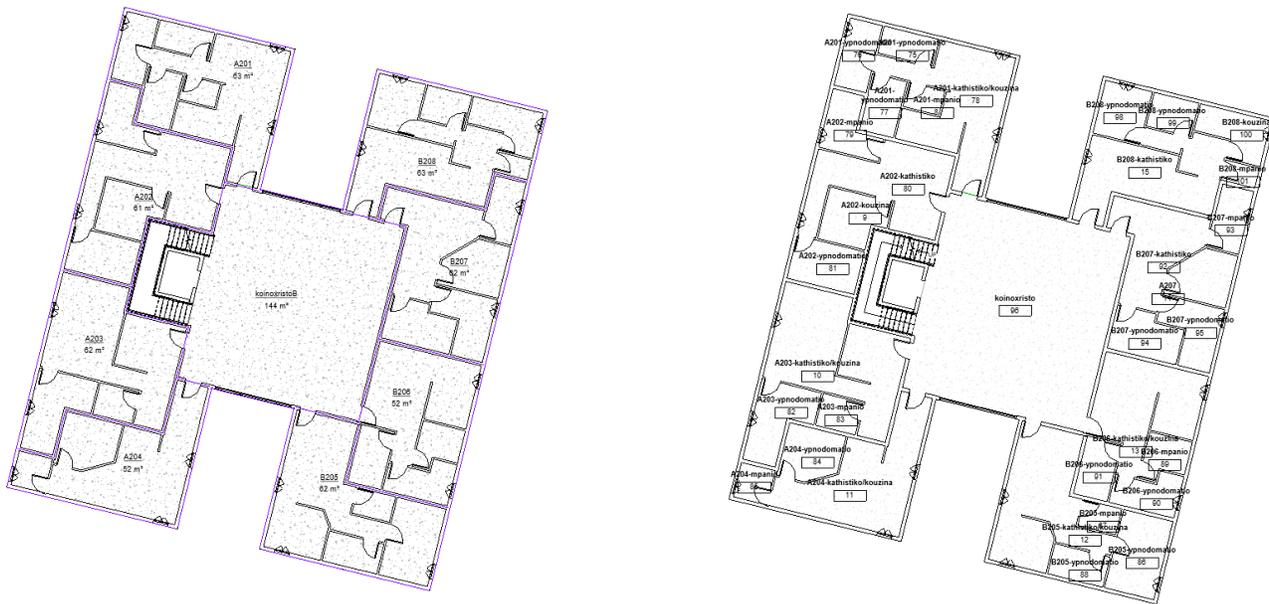
Εικόνα 36: Κάτοψη δεύτερου ορόφου μόνο τα διαμερίσματα ( Area plans ( Gross Building ) , Κάτοψη δεύτερου ορόφου με τους εσωτερικούς χώρους ( Floor Plan )
