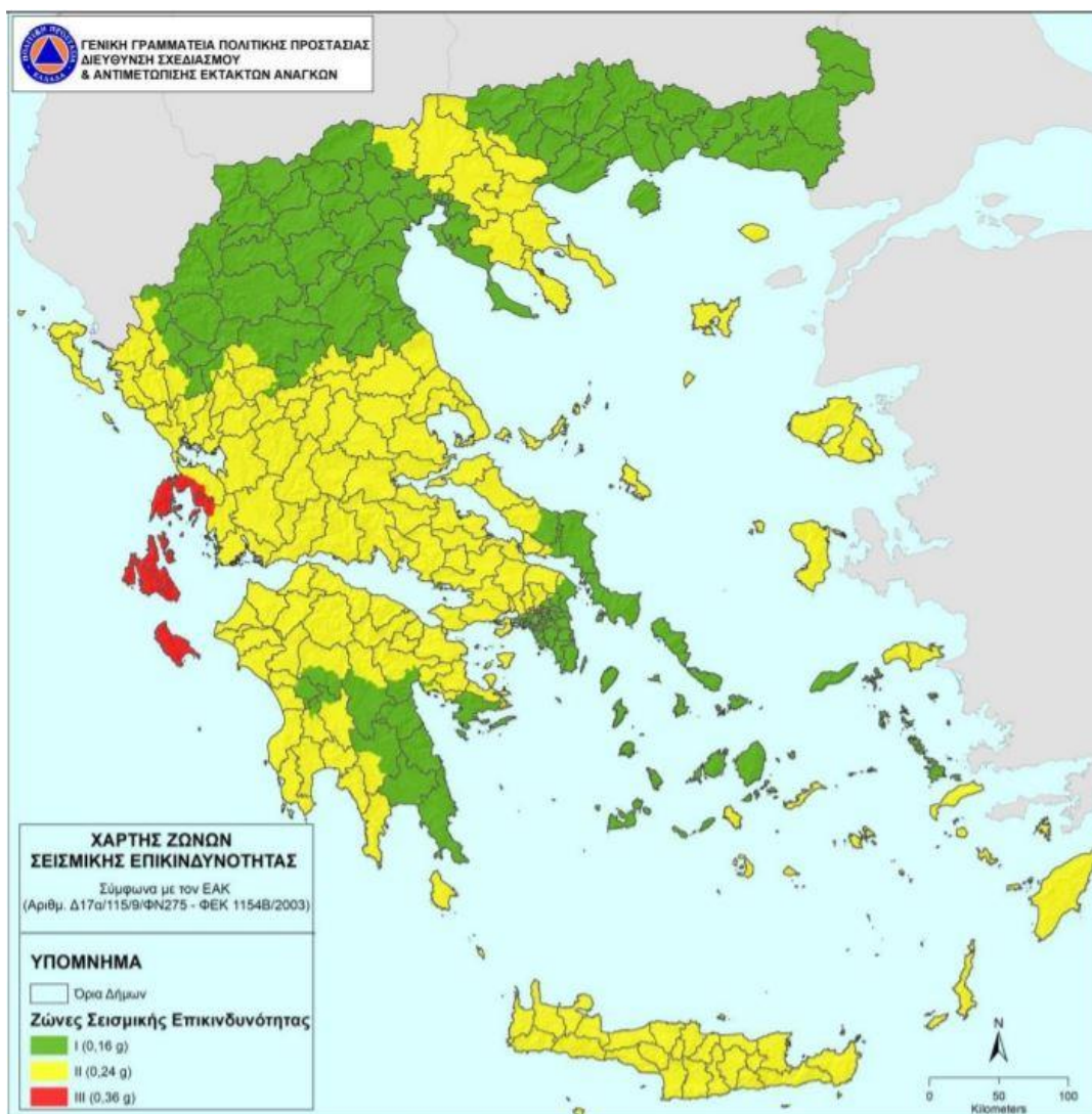
Εικόνα 2 Χάρτης Σεισμικής Επικινδυνότητας της Ελλάδας σε σχέση με τα όρια των Δήμων.
