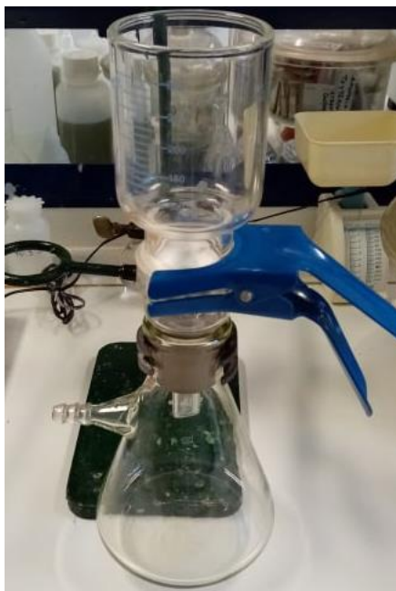
Εικόνα 10.2: Συσκευή διήθησης διαλύματος ερυθράς ιλύος-φωσφορικού οξέος
