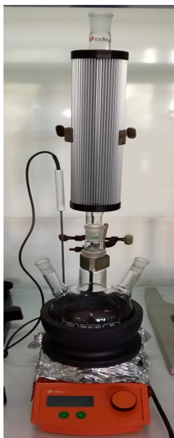
Εικόνα 10.1: Διάταξη σφαιρικής φιάλης-μαγνητικής πλάκας για τα πειράματα έκπλυσης
