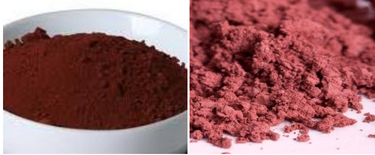
Εικόνα 3.6: α) Λειοτριβημένη ξηρή ερυθρά ιλύς (αριστερά) και β) σιδηροαλουμίνα (δεξιά)
