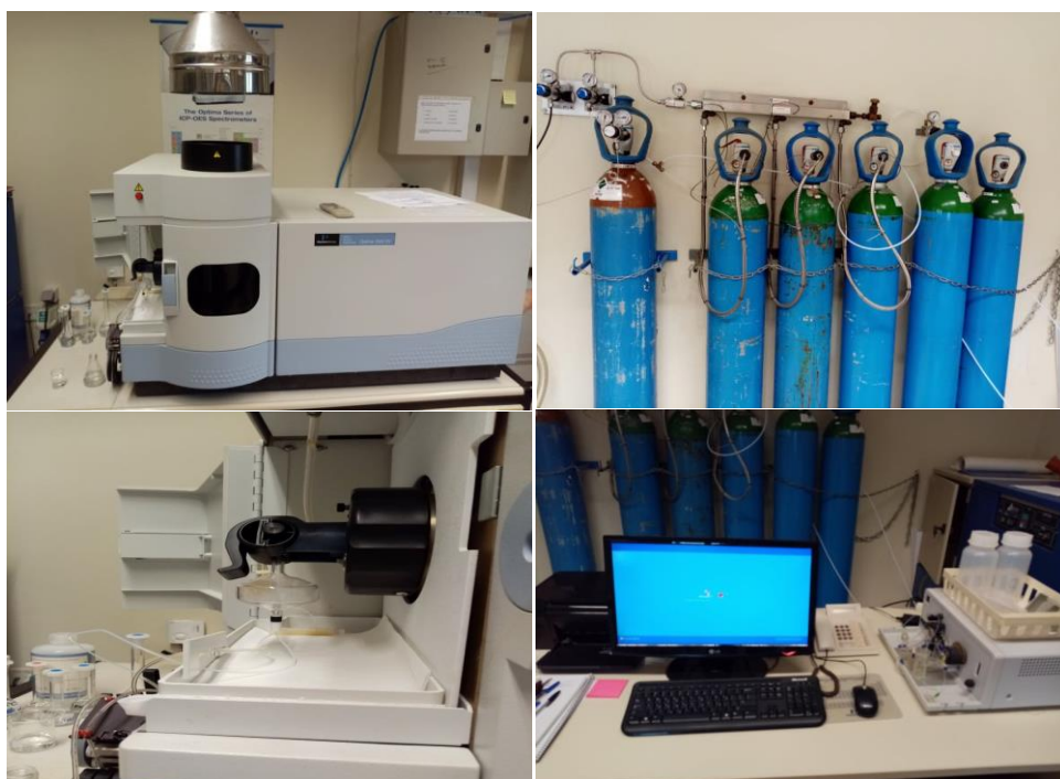
Εικόνες 9.1: (α) Φασματοφωτόμετρο Optima 7000DV διαδοχικής ανάλυσης Parkin Elmer (επάνω αριστερά) , (β) Φιάλες αδρανών αερίων (επάνω δεξιά) , (γ) Εκνεφωτής δείγματος (κάτω αριστερά) , (δ) Σύστημα Η/Υ συνδεδεμένο με τη διάταξη του φασματοφωτόμετρου (κάτω δεξιά)
