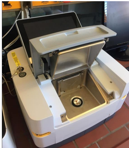
Εικόνα 9.2: Φασματοφωτόμετρο φασματοσκοπίας φθορισμού XRF, Model Epsilon 1 της εταιρείας Malvern Panalytical
