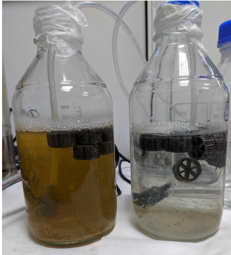
Εικόνα 10: Πείραμα batch για τον προσδιορισμό της ταχύτητας νιτρωδοποίησης του βιοφίλμ
