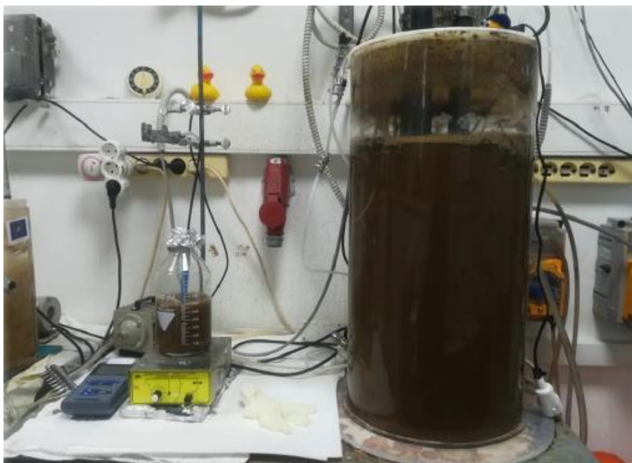
Εικόνα 9: Πείραμα μέτρησης ταχύτητας νιτρωδοποίησης και απονιτρωδοποίησης σε batch αντιδραστήρα χωρίς βιοφορείς (αριστερά) και στον αντιδραστήρα IFAS-SBR (δεξιά)
